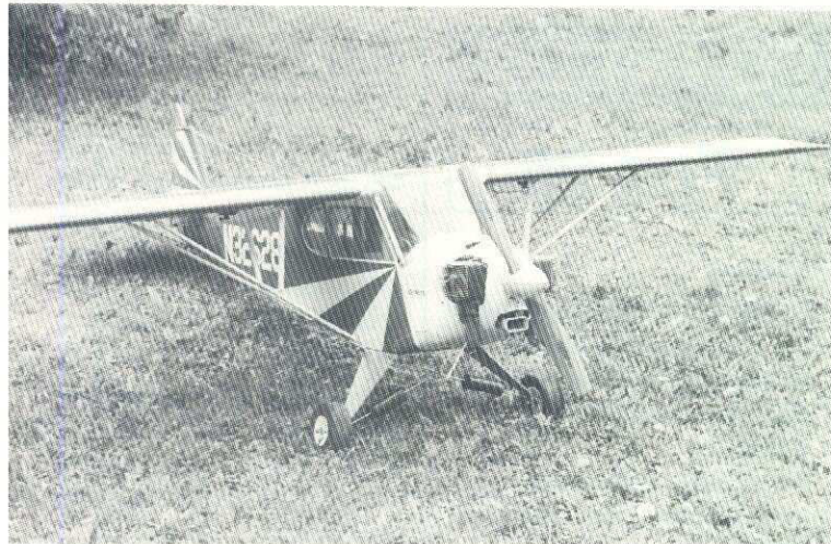
Här har Cuben utrustats med en tvåcylindrig Tartan-motor
