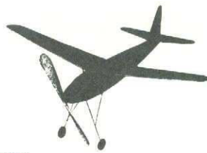
Trumf Spännvidd 50 cm. Trevlig flygkroppsmo- dell i fackverkskon- struktion med utmärkt flygförmåga.
