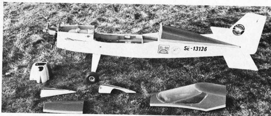
Tankutrymmet. Observera skyddande skumplast runt tanken samt mot spannet.
