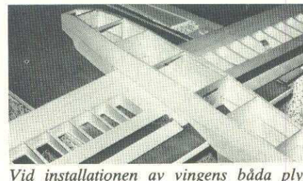
Vid installationen av vingens båda plywoodfastsättningar läggs vingen upp och ned på byggbrädan. Därefter placeras kroppen ovanpå vingmitten.
