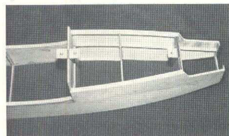
Framkroppen. De fyrkantiga bitarna är plywoodfastsättningar för lucka och huv.
