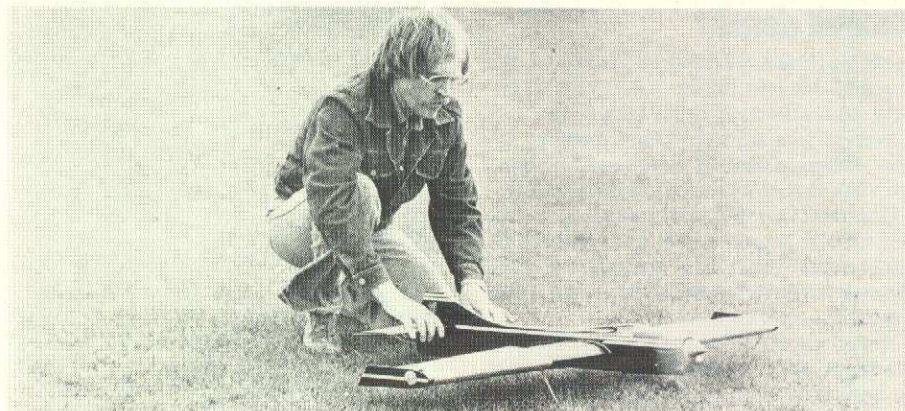
Håll modellen så att piloten ser utslagen på rodret. Håll stadigt och släpp först på pilotens klartecken.
