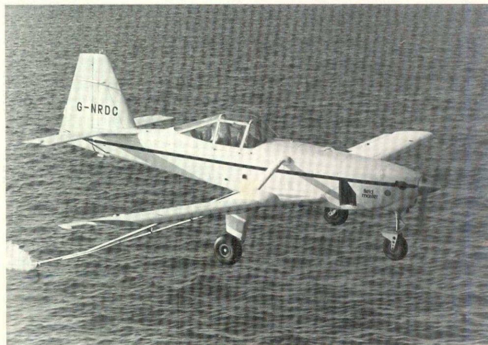
NDN Fieldmaster suger upp vattnet via en fällbar bom.
