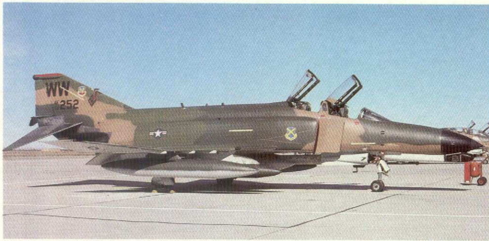
F-4G Phantom II är en specialversion för bekämpning av Lv-radarställningar. F-4G kan bära de signalsökande robotarna Shrike och Standard ARM. Foto: EMCS.
