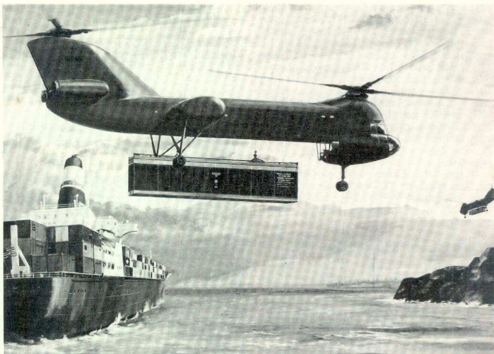
Att lasta och lossa containerfartyg till havs är ett framtidsperspektiv med Boeing XCH-62.
