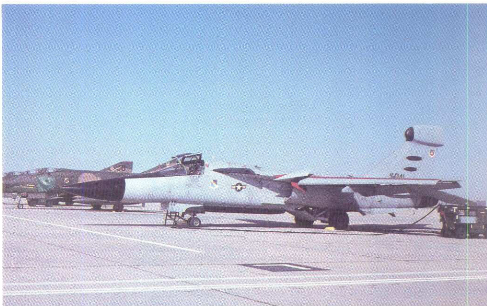
EF-111A Raven är den senaste F-111-versionen. Den har till uppgift att elektroniskt störa både fiendens radar och radiokommunikation. Foto: MIL-slides.
