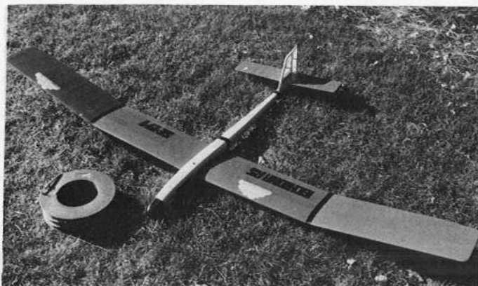
En 2-metare klädd med Solartex och WIK-repet på Tele-spole.
