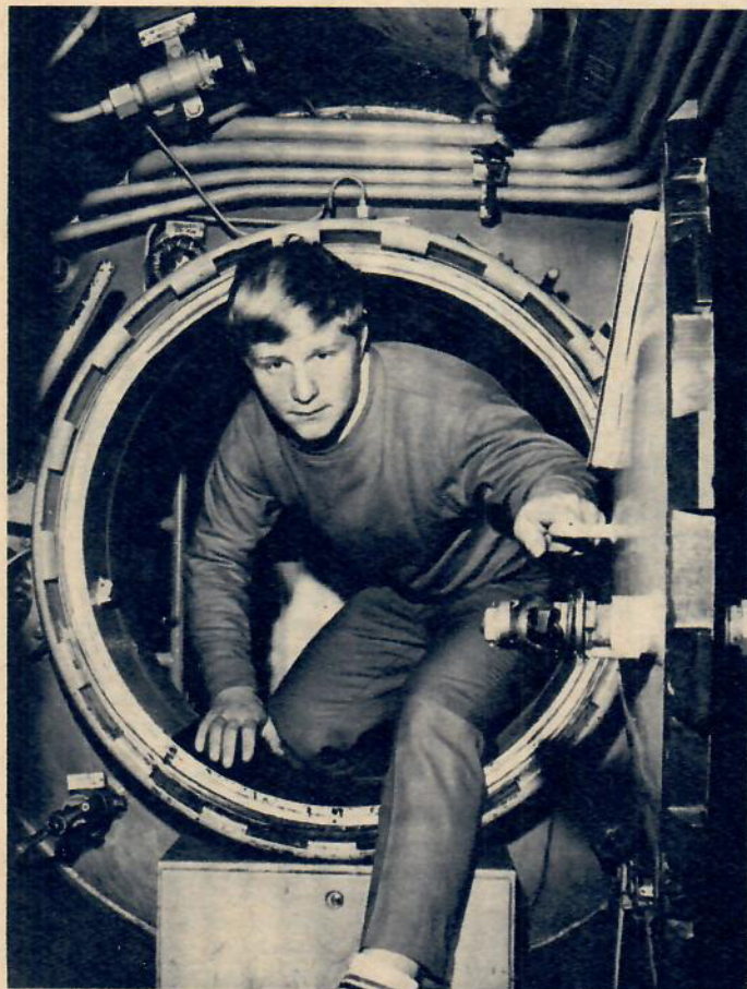
Akta huvudet! Dörrarna håller inte stånd ombord på flottans ubåtar. Här tar sig Karle igenom dörren i ett skott. Med sådana ståldörrar delas båten i sektioner som är tryck- och vattentätt avskilda från varandra.
