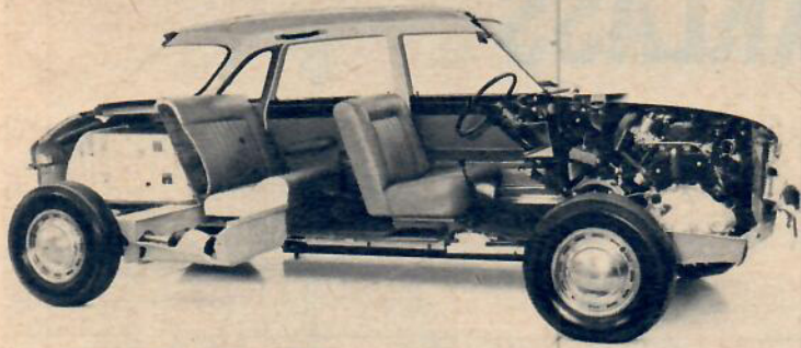
Den här bilden av en kliven BMC 1800 visar hur väl man tillveratagit alla utrymmen. Observera det för biltypen ovanligt stora bagageutrymmet!
