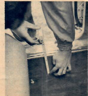
Urstigningen var inte helt bekväm. En tröskel på 17,5 cm måste klivas över i den låga vagnen!
