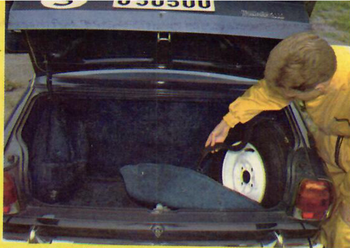
Bagageutrymmet är visserligen ovanligt djupt genom att bränsletanken är placerad framför och inte under bagaget, men både bredd och längd lämnar en del övrigt att önska. Reservhjulet står snett och stjäl en hel del plats.
