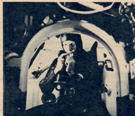
En attackdykare är här klar för att slussas ut från dvärgubåten Spiggen. Dykaren kan ta sig ut och in igen utan att avslöja båtens position.
