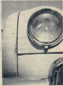
Framskärmens skarv och infattning för strålkastaren kan ibland angripas av rosten.
