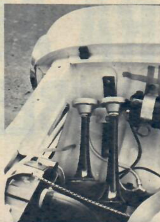
Det är viktigt att hornen blir riktigt monterade. Vridna till det här läget blev ljudstyrkan framför bilen mycket lägre.
