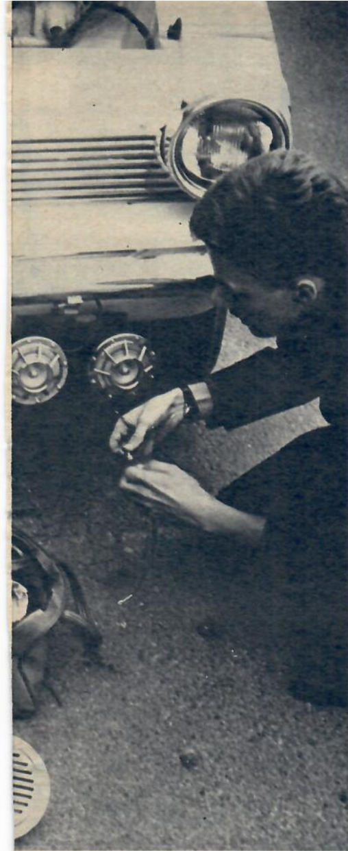
Snett nedåt-framåt är bästa monteringen för kompressorhornens trattar. Så här satt Fiamm och Marchal vid våra prov.
