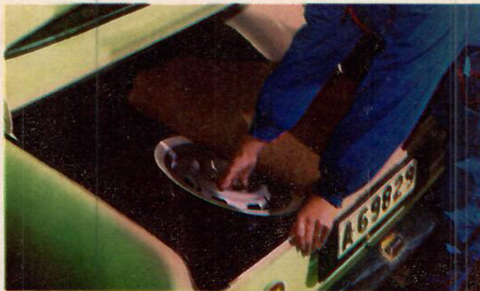
Reservhjulet ligger infällt i bensintanken och stjälar inget extra utrymme i bagageavdelningen. Detta är praktiskt, eftersom reserven sällan behövs.
