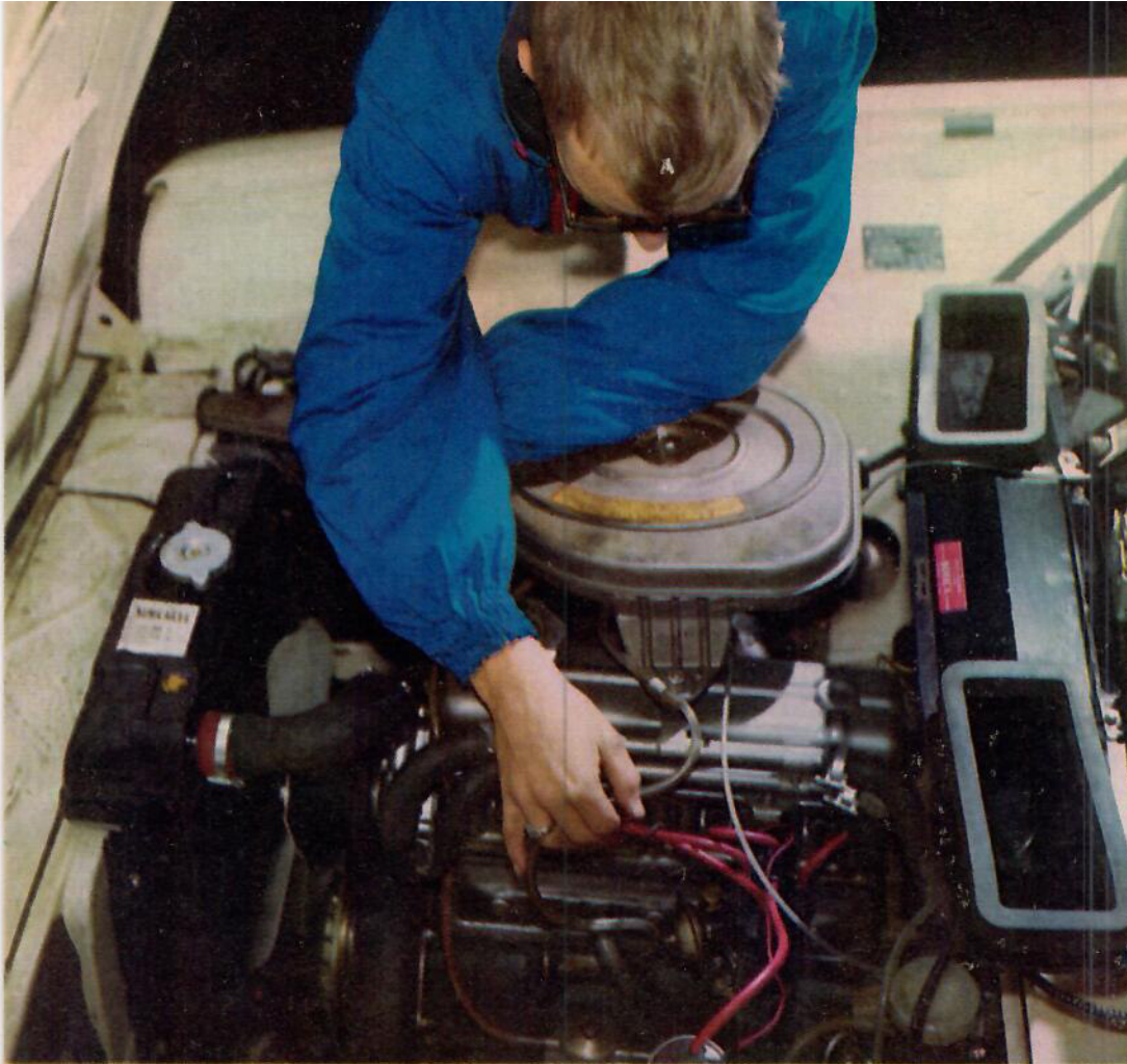
Motorn är ett »arv» från Simca Aronde men ger nu 62 hk SAE (i modell 1500 81 hk). Observera de stora intagen för friskluft framför vindrutan.
