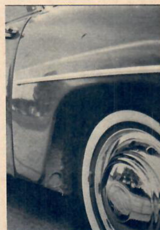
Ytorna i skärmhusen är ganska fria från skrymslen men kolla ändå främre delen av bakskrävarna.
