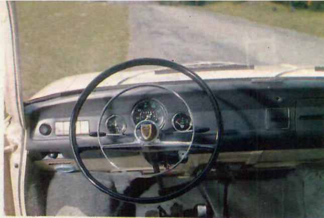
Instrumenteringen är centralt grupperad och tydlig. Särskilt hastighetsmätaren hör till de mest lättavlästa instrumenten.
