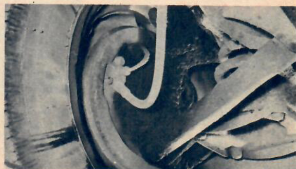
Som på alla bilmärken gäller också här att se upp med hiulupphängning och kolla bromsledningar.
