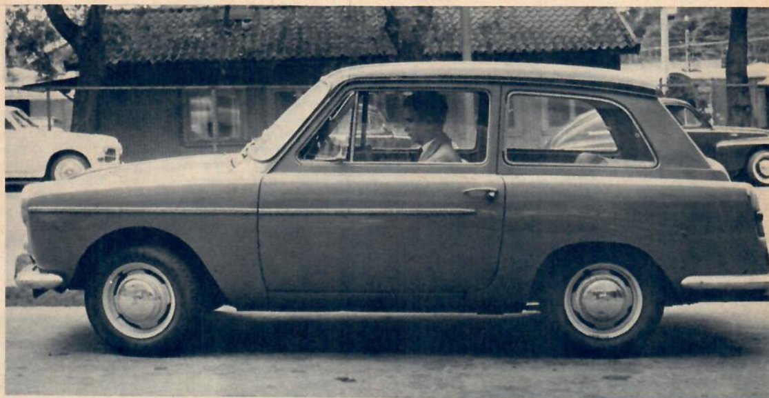
Austin Futura har en robust uppbyggnad och inte några speciellt rostvänliga skrymslen. Är relativt slitstark.
