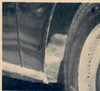
Plats för rostangrepp är bakre delen av den främre stänkskärmen.
