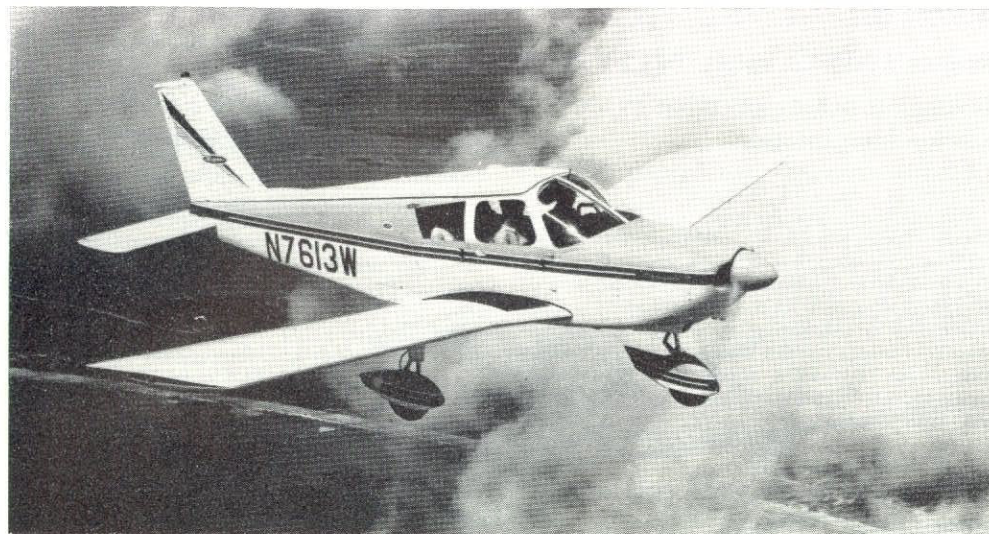
Cherokee 235, lämpligt även för minsta flygstråk. Toppfart 265 km/tim. Lastar mer än sin egen vikt.
