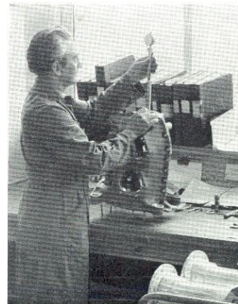
Uppmätning av vevhus
