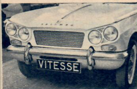
Triumph Vitesse 6. 4-sitsig, 2-dörrars. 6-cyl. motor på 70 SAE-hk. Fart ca 140 km. Minsta sexa både i fråga om motor och kaross.
