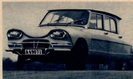
Citroën AMI 6. 4-sitsig, 4-dörrars. 2-cyl. motor på 22 HAE hk. Toppfart: 105 km. Modellen slår inte i Sverige — alldeles för originell och dyr. 53 ex. i föl.
