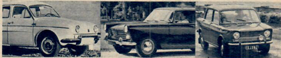
Renault Dauphine-Gordini. 4-sitsig, 4-dörrars. 4-cyl motor på 40 SAE hk. Motorn bak. Toppfart nära 130 km/t. 3.237 ex. sålda här i fjol.
