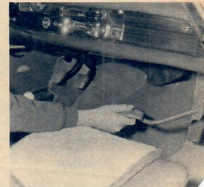
Men med några handgrepp och en skiftnyckel är dubbelkommandopedalerna applicerade på sin plats.
