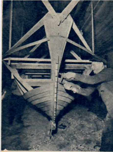
Vid ett klinkbåtbygge är det svåraste vid bordläggningen att lägga det första bordet intill kölstocken. Bordet kräver kraftig basning vid förskeppet.
