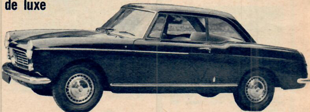
Peugeot 404 Coupé är den senaste skapelsen av de fåtaliga franska lyxbilarna (extrema sportvagnar såsom Facel Vega då undantagna). Peugeot-kupén har en 4-cyl. direktinsprutad radmotor på 85 SAE hk. Toppfart över 160 km/t.
