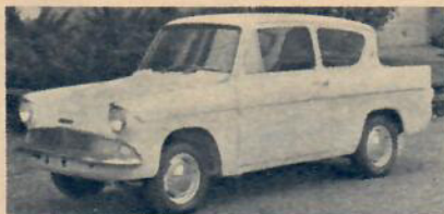
Ford Anglia. 4-sitsig, 2-dörrars. 4-cyl. motor på 40 SAE-hk. Toppfart: 125 km. Mest sålda engelsman i Sverige i fjoll — 2.723 exemplar.
