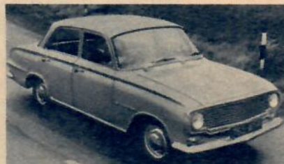
Vauxhall Victor, 3-växlad version. 5-sitsig, 4-dörrars. 4-cyl. motor på 50 DIN-hk. Fart: 125 km. 1.866 sålda Victor 1962.
