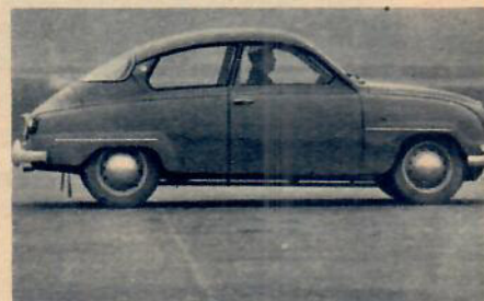
Saab 96, 5-sitsig, 2-dörrars, 3-cyl. tvåtaktsmotor på 42 SAE hk. Toppfart 125 km/t. Gick i fjol upp som den mest köpta svenska modellen — 22.680 ex.
