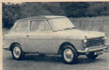
Austin A40 stationsvagn. 4-sitsig, 2-dörrars. 4-cyl. motor på 50 SAE-hk. Fart: ca 120 km. 1962: 648 sålda A 40-bilar.
