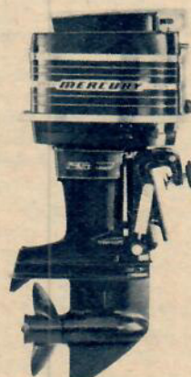
MERCURY 650 Mercurys kraftigaste "fyra". 4 cylindrar 65 Hk.
