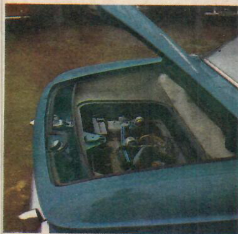
Motorn ligger väl inpackad under bakre bagageutrymmet. För att ge något utrymme för bagaget ovanför har motorn gjorts mer »pannkaksbetonad» än någon annan. Jämförbar endast med VW Variant.
