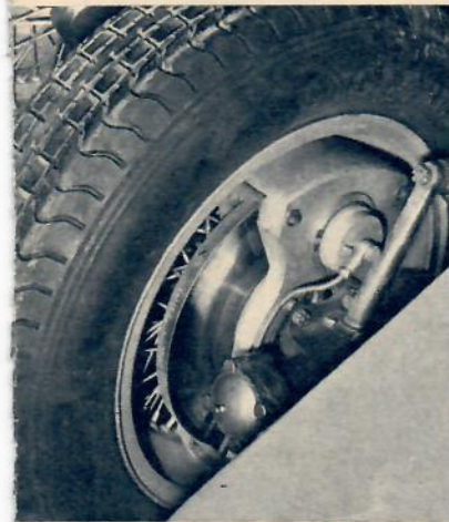
Gordini använde skivbromsar redan för sju år sedan — ovan ser vi ett aggregat på den åttacylindriga formelbilen. Nedan: Utsikten från förarplatsen i F II-racern med sexan på två liter. Notera växelspakens läge!
