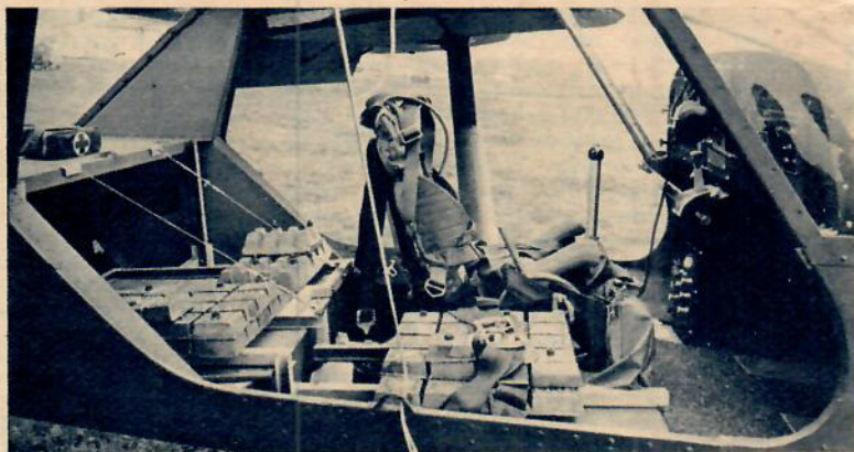
Under provflygningarna är Vipan fullastad med bly. Så gott som alla prov måste nämligen göras med ett maximum av belastning.
