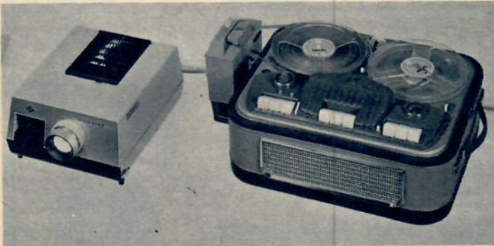
Så här kan man arrangera en automatisk färgbildvisning med ljud. Projektorn förbinds via en impuls-givare med en bandspelare. Lagrade impulser på bandet växlar bilderna på rätt ställen i texten.
