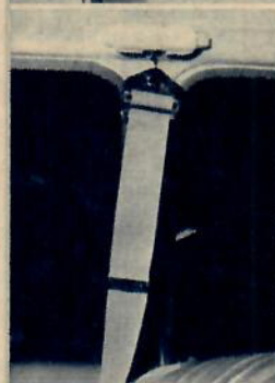
Morris 1100 hör till de vagnar där bältets fästpunkt sitter betydligt över axelhöjd.
