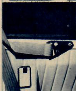
Saabs låga fästpunkt kompenseras delvis av att den sitter långt bak. Bältet nära halsen.
