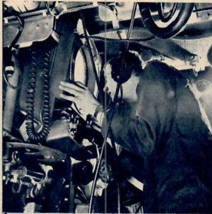
Vattenprov lämnar besked om de korrigeringar i hydrofoncentralen som är nödvändiga.
