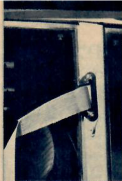
Övre fästpunkten skall sitta i axelhöjd eller högre som i exempelvis Opel Rekord.
