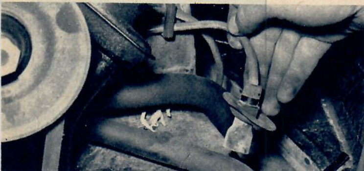
Vid felsökning i elsystemet kan man prova om det blir gnista genom att lossa tändstiftskabeln och se om det blir gnista mellan kabeln och blocket. Tändningen måste givetvis vara tillslagen och startmotorn i gång.
