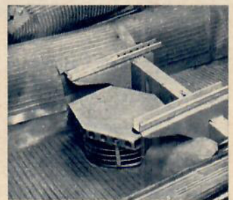
Boschs undersitsvärmare kan placeras under vilket av bilens säten som helst och kan riktas efter önskemål. Ovan placerad i en Volvo.
