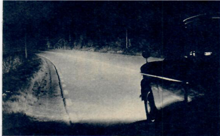
FEL. HELLJuset på den egna bilen släcker ut den varning skenet från den mötandes strålkastare ger. Förhållandet blir detsamma före backkrön.
