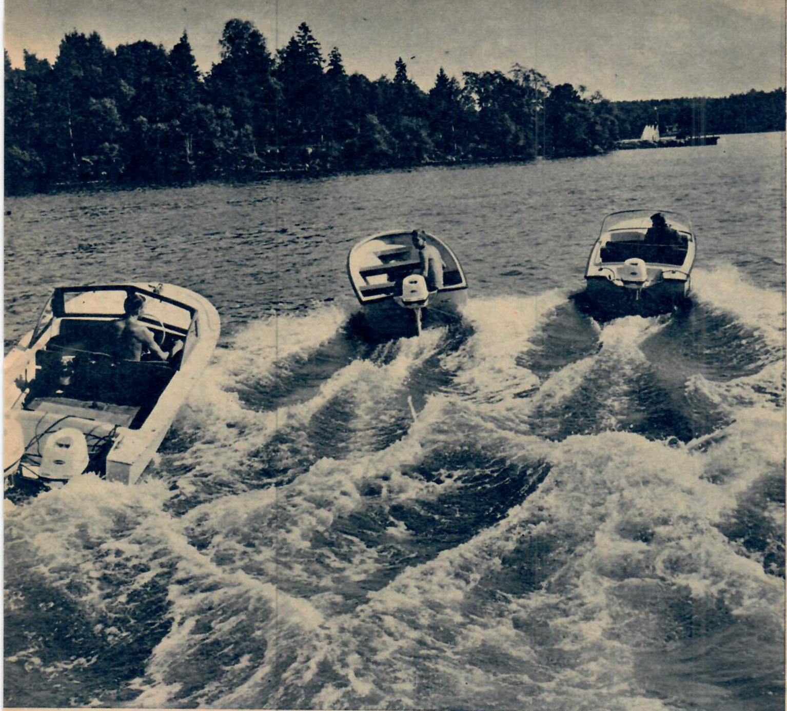
Den nya 22 hk motorn provkördes på flera olika båttyper samtidigt. En av båtarna kördes också med dubbla motorer och hade noggranna mätinstrument.
