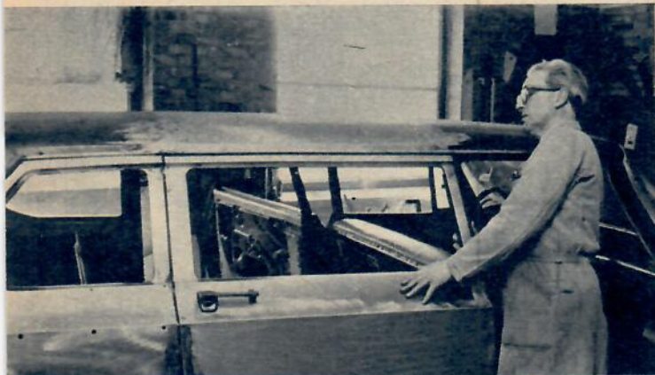
Vid den 70 centimeter långa förlängningen måste bl. a. bakkörrarna göras om för att passa den nya karossen. Fabrikör I. Heinels inspekterar taket.
