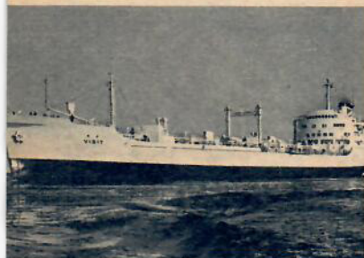
Asfalttankern Vibit, som levererades från Götaverken i februari, har värmeslingor i lasttankarna för att hålla asfalten flytande under transporten. Temperatur upp till +150° C.
