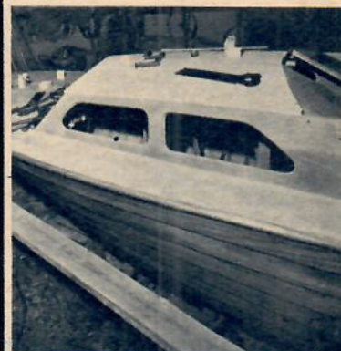
Professionella båtbyggare gör nästan alltid däckan av ribbor och med kittade nåtskarvar mellan dem.
