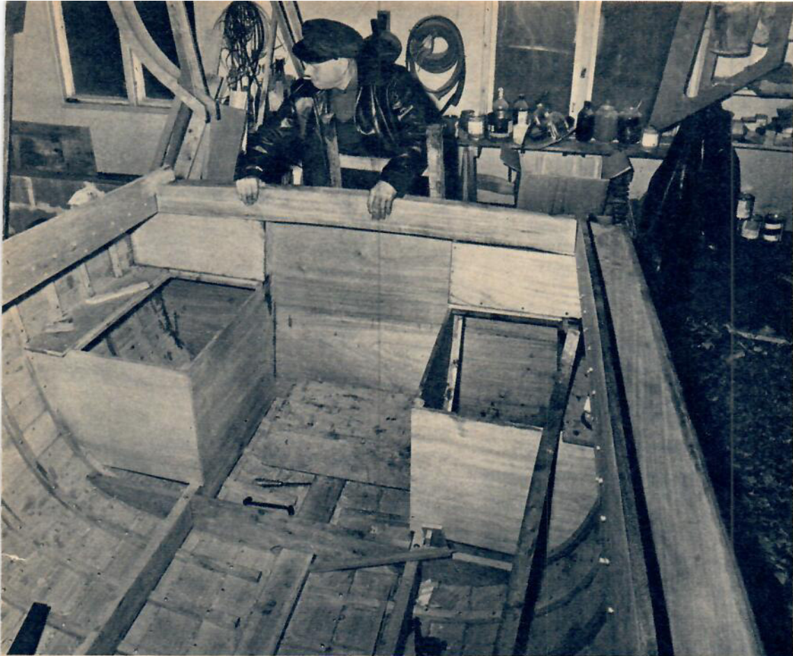
Inombordare med utbordardrev kräver en bastant akterspegel. Aggregatet fixeras med hjälp av genomgående bultar.
