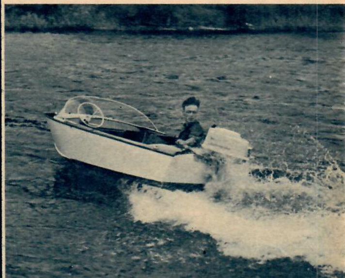
Med en 18 hästkrafters Johnsonmotor fick Ragette en mycket stabil gång utan några tendenser till stjälpning ens vid mycket töra svängar. Fart 22 knop med en person.
