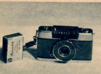
Olympus Pen, japansk halvformatkamera, som tar 72 rätt exponerade bilder på en vanlig småbildsrulle avsedd för 36 exponeringar.
