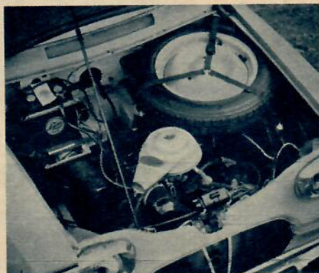
Motorn på 22 hästar väsnas väl mycket — speciellt på de lägre växellarna. Reservhjulet förvaras i motorrummet.
