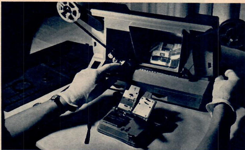
Med en så här fin viewer — med stor och ljus bild — är det inga svårigheter att bedöma varje bilds kvalitet. Skarvapparaten är dubbelsidigt verkande, d v s skrapar båda ändarna på filmen på en gång.
