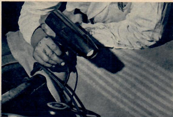
Med en syraprovare är det tämligen enkelt att undersöka batteriets laddningsgrad, bilden ovan. Vid tändningsinställning används s. k. glimlampa. Med den ser man om tändningen sker vid rätt tidpunkt, bilden nedan.
