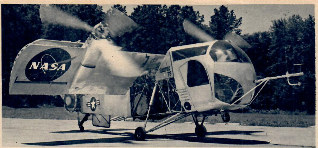
Vertol-76 kallas denna föga vackra skapelse som här provas vid amerikanska statens testanstalt i Langley Field. Spännvidden 8 m, längden 9 m.
