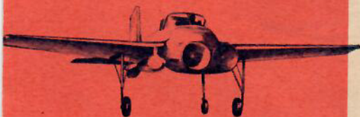
Bell X-14 var det första VTOL-plan som utrustades med samma motorer för vertikalstart och framdrivning. De vridbara motorerna är av typ Bristol Siddeley.
