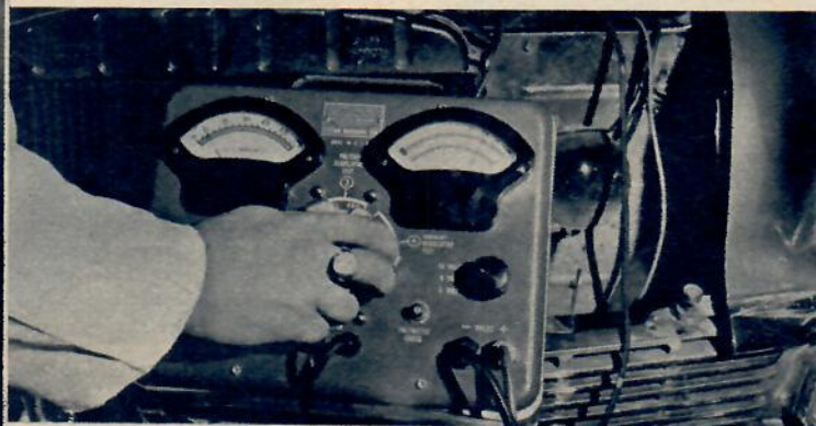
Instrumentet ovan är en volt- och amperemeter med inbyggt belastningsmätstånd och korskoppling för fältkrets. Används bl. a. för kontroll av generatorns laddning och startmotorn. Under en kompressionsmätare.
