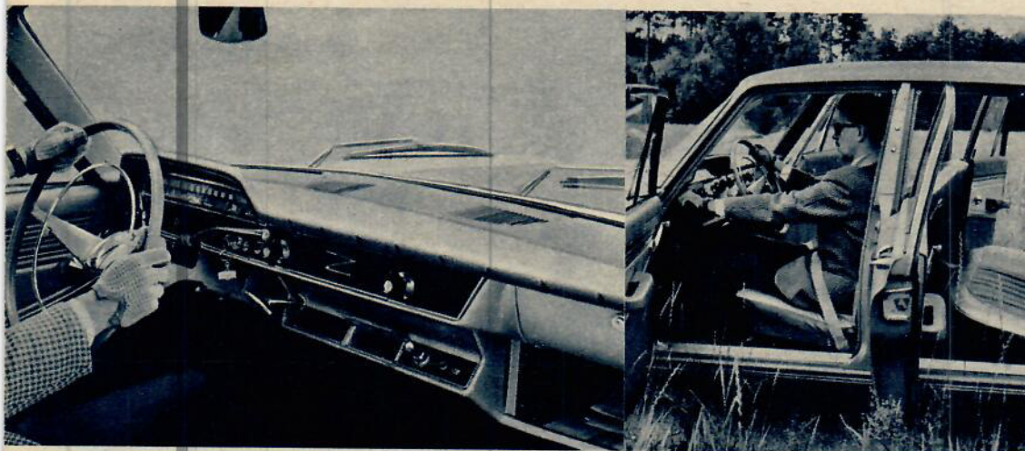
Instrumentpanelens reglage är litet väl utspridda. Som synes skymmer signallringen en del av hastighetsmätaren. Instrumenten är få.
