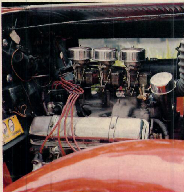
Tre Strombergförgasare sitter på modifierade Rocketmotorn, en V8.
