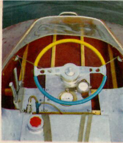
Reglagen i Strandbergs båt är enkla. Ett gas-handtag, varvräknare och manometer som visar trycket i tanken, som syns närmast kameran.
