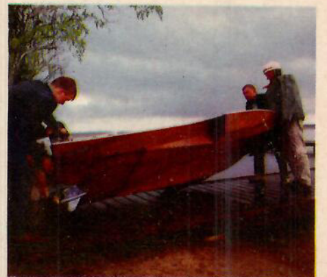
Här ges en aning om bottenformen. Framre delen är konkav — här bildas luftkudden — medan bakkdelen är konvex för »släppets» skull.
