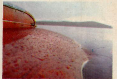
Skrovytan är noga behandlad, först med plast och sedan med vanligt bilvax. Vi ser hur vattendropparna samlar sig i små pärlor på skrovot.
