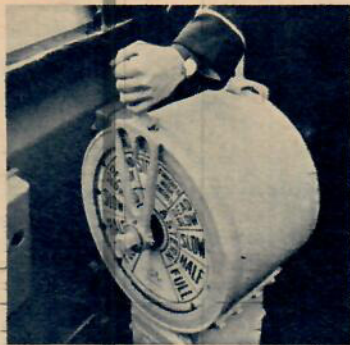
Maskintelegrafen ringer. Från bryggan slås stopp i maskin, och via högtalare ges order till däck och bogserare.
