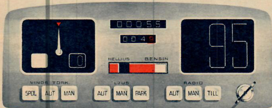
En lättläst instrumentpanel hör till bilden av bilen 1970. Lägg märke till hastighetsmätaren av digitaltyp med stora, lättlästa siffror. Eller den exakta bensinmätaren av termometertyp. Instrumentet till vänster varnar vid fel.
