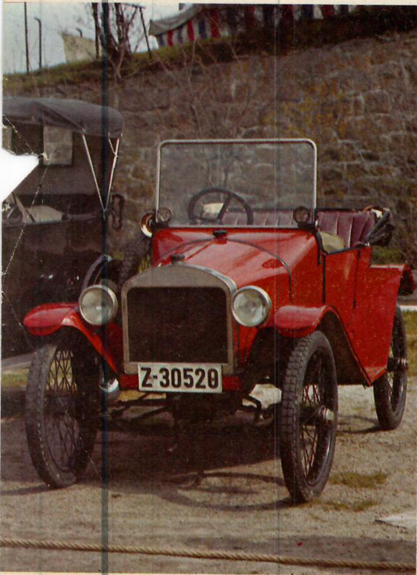
Trumbull är ett mycket sällsynt märke även i hemlandet Amerika. Det här exemplaret är byggt 1915 och har en motor med sidventiler och 4 cylindrar.
