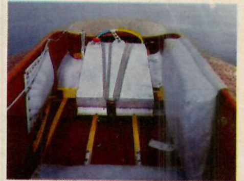
Föraren får inte slänga hit och dit i båten, därför är den madrasserad på vitala punkter. Trycktanken ligger mitt under bröstkorgen!
