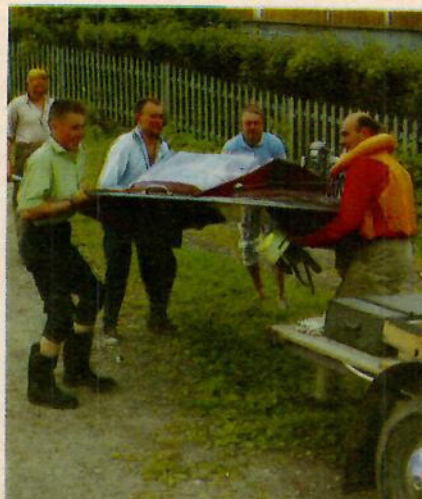
Här ges en aning om bottenformen. Framre delen är konkav — här bildas luftkudden — medan bakkdelen är konvex för »släppets» skull.
