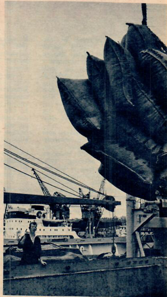
Luckbasen dirigerar från däcket kranen på kajen och ser till att inga stuvare är i vägen när de tunga kroken firas ner i lastrummets djup.
