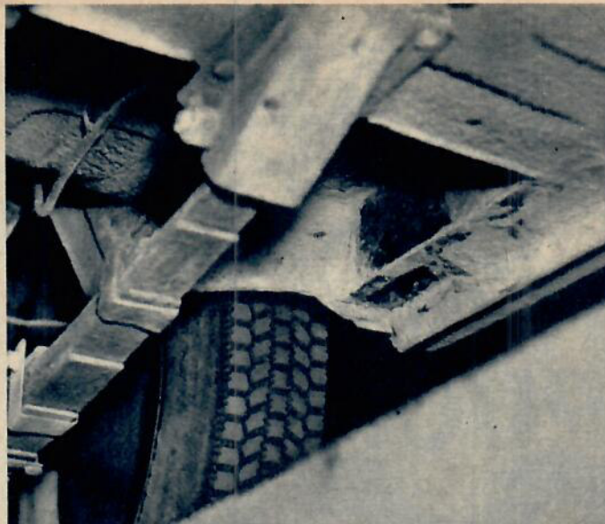
Liksom de flesta andra bilar är Fiat rostkänslig i tröskellådorna under dörrarna. Dessa rostskador finns på den äldre modellen just framför bakhjulen. De hade dock inte fått någon större omfattning och kan lagas för ett vettigt pris.
