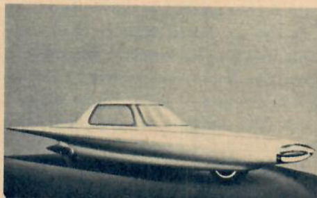
Ford forskar för framtiden! Ford Gyron-bilen som tänker själv — en tvåhjulig drömvagn utan ratt och pedaler men med elektronhjärna och gyroskop.
