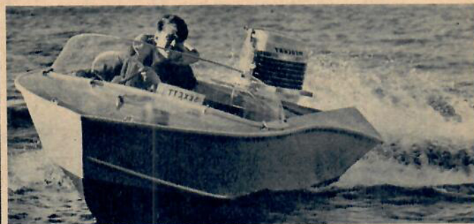
Med en 45 hk motor gör Sexett 30 knop och med en 10 hk 16—18 knop. Båten kan även göras bäddbar. Byggsatsen säljs av Bruhners Marin i Stockholm, som här visar prototypen i aktion.
