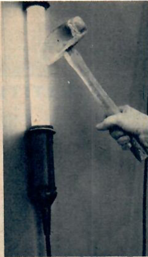
Detta är en okrossbar s. k. sladd-lampa. Den tål t. o. m. det tryck som uppstår när en bil går över den. En helsvensk konstruktion!
