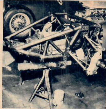
Växellådan till Ferraris svansmotorvagn är placerad bakom bakaxeln. Bakom lådan sitter den luftkylda flerskiviga kopplingen.
