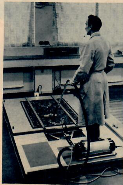
En bildsvit från världens mest fullständigt utrustade dammsugarlaboratorium. Överst t. v. rengörs en matta från gammalt damm innan den på nytt dammas för provsugning. Roterande läderband piskar matan samtidigt som den sugs nedifrån. Övan t. h. provsugs en matta. Sugeffekten och kraften på munstycket mäts. Nedan långtidsprovning av olika dammsugarfabrikat. De körs 500 timmar.
