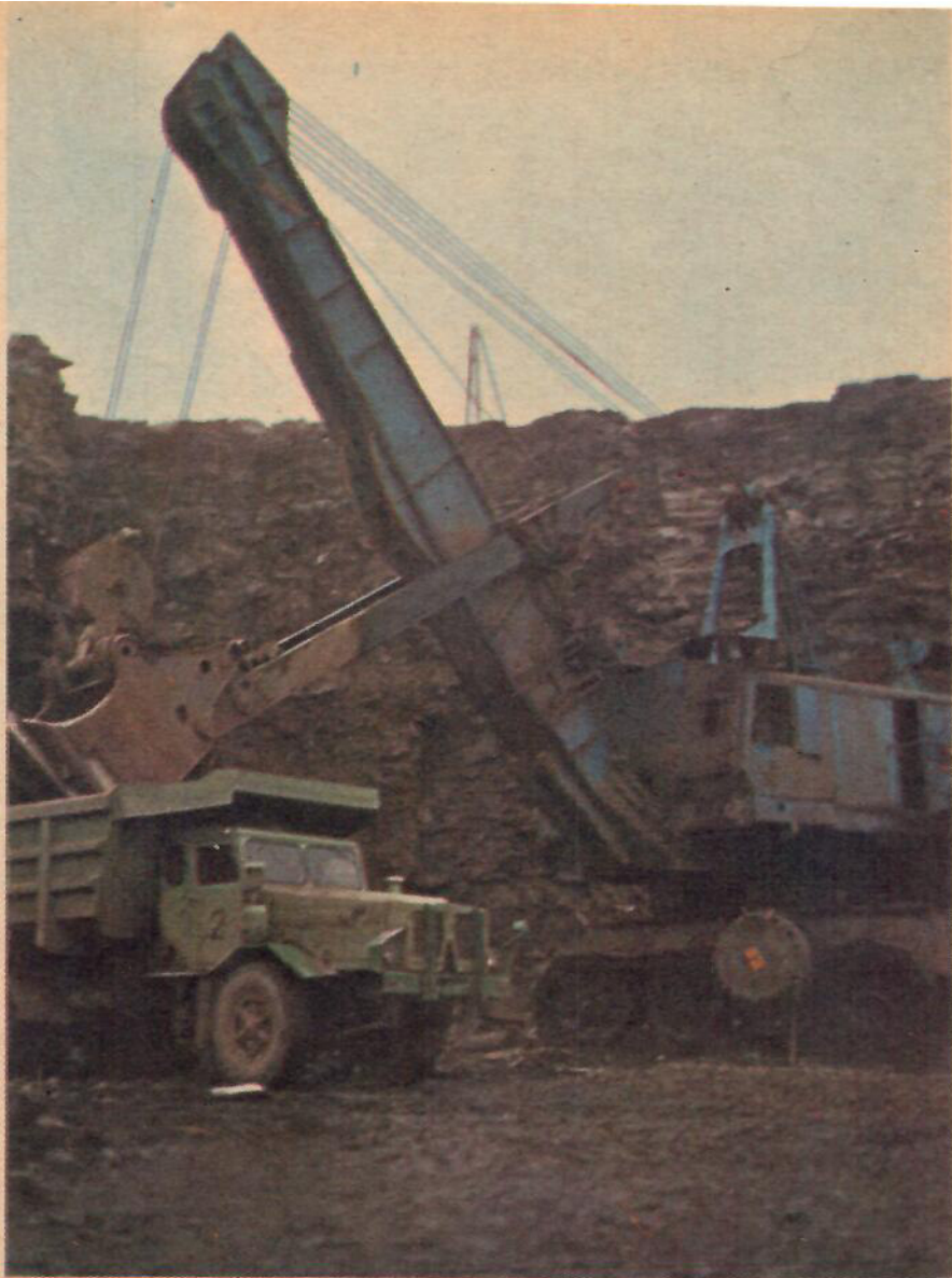
I dagbrottet bryter stora lastmaskiner loss skiffen som luckrats upp genom sprängning med krut. Skiffen lastas på truckar som transporterar den till en järnväg för vidarebefordran till krossarna vid verket. I brottet arbetar man i två skift och bryter omkring 9.000 ton skiffer om dygnet. Nedan en motor som används för bestämning av bensinens oktantal. Bensinens knockningsegenskaper jämförs med en blandning av två bränslen med noga känt oktantal.
