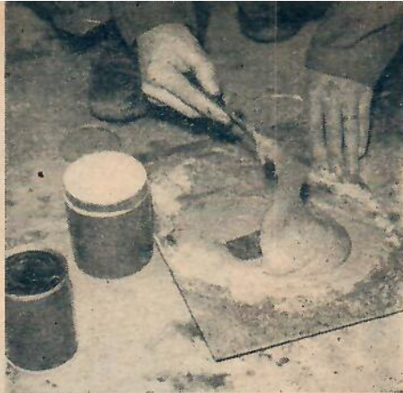
När massan har blivit till en tjock gröt är den färdig att användas. Torka av verktygen innan plasten hinner stelna. Sedan är det för sent.
