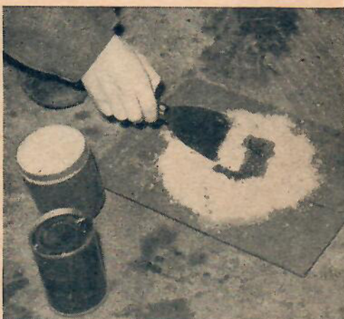
Plastpulvret hälls ut på en masonitskiva och hårdaren hälls på. Det är ungefär som att röra till cement. Se till att massan blir jämn!
