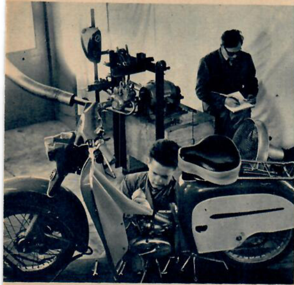
Alla inhemska och importerade mopeder granskas i detalj innan typintyg utfärdas. Bland annat väger man ut effekten som aldrig får överstiga 0,8 hk. Vid bromsbänken ingenjör Karl Axel Assmundson.
