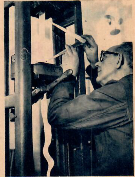
Dragprovningmaskin med ett band från ett säkerhetsbälte fastsatt för provning. Innan belastningen läggs på mäts längden och töjningen kontrolleras sedan ända tills bandet bryter.
