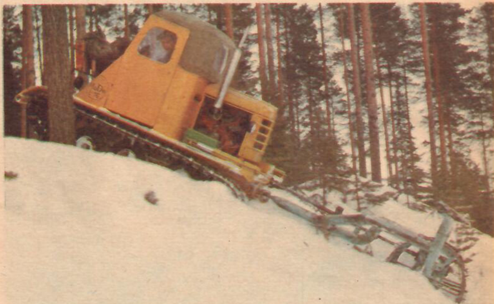
Motlut, djup snö och obanad terräng i allmänhet är som synes inget hinder för Sandbergsvesslan. På slät väg har man måst begränsa dess hastighet till 30 km/t., men den kan gå betydligt fortare.
