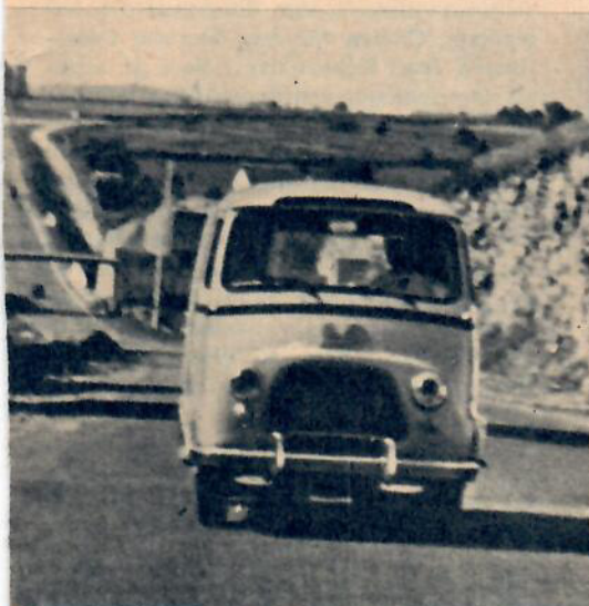
Renault har redan en framhjulsdreven modell som den här skåpvagnen. Den har en lastförmåga på 600 kg.
