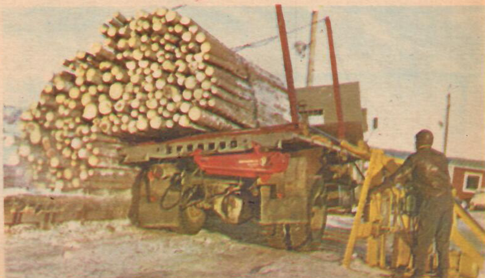
Avlastningen av det bilburna virket sker synnerligen rationellt. Lassen buntas med grov ståltråd medan de ligger på bilen och sedan skjuter två elektronhydrauliska armar ned hela bunten i vattnet.
