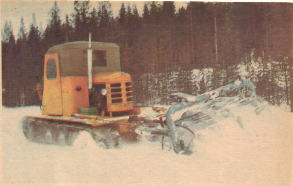
Här är Sandbergsvesslan kopplad till en s. k. snövält som drivs från vesslans kraftuttag. Välten både packar och smular sönder snötäcket och där den gått fram kan man köra med lastbil.
