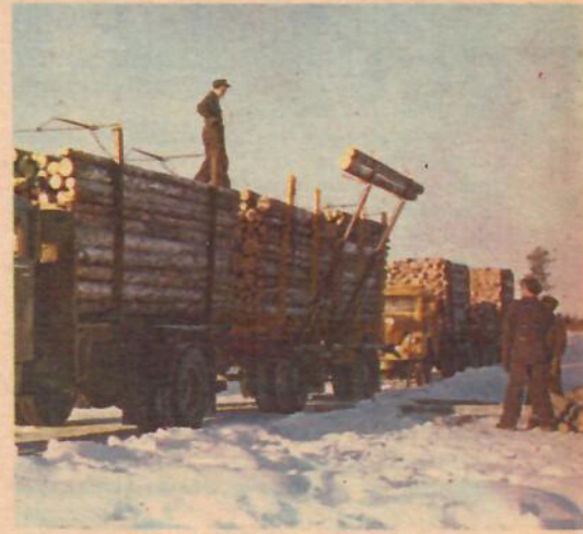
Även lastningen på bilarna sker med maskin. Armarna lyfter automatiskt och i jämn takt.
