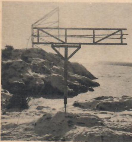
Från en sändarantenn riktas en radarstråle längs den beräknade flygbanan. Radarstrålen reflekteras av en koppartråd i modellen...
