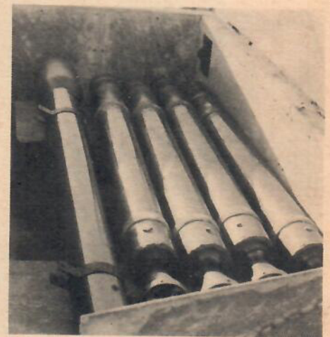
Drivkällan är en krutraket — Flygvapnets standardraket. Stridsspetsen har givetvis monterats av. Här fyra raketmotorer och ett stridsraket.
