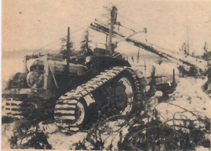
Vinschen på traktorn släpar fram virket till stickvägen och lyfter sedan upp det på lasset t. v. I verkligt svår terräng där varken häst eller traktor går vinschar man fram virket med linbana t. h.
