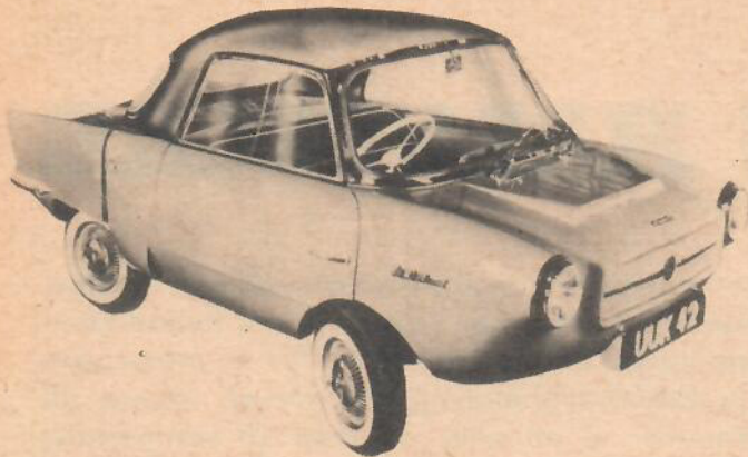
Engelsmännens Meadows Frisky förekommer både som cabriolet och täckt modell. Frisky tillhör det fåtal av minibilar som har separat chassi. Den har en kraftig rörram som verkar mycket robust.
