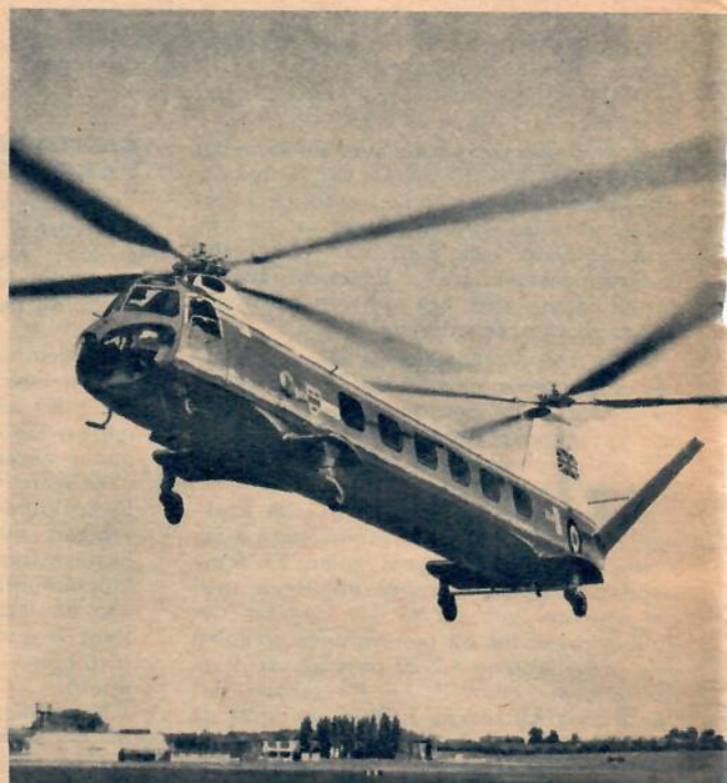
Bristols tandemhelikopter med två Napier Gazelle gasturbiner på vardera ca 1.500 hk. Provflygningar pågår just nu och om dessa visar gynnsamma resultat kan koptern bli en verklig »luftbuss».
