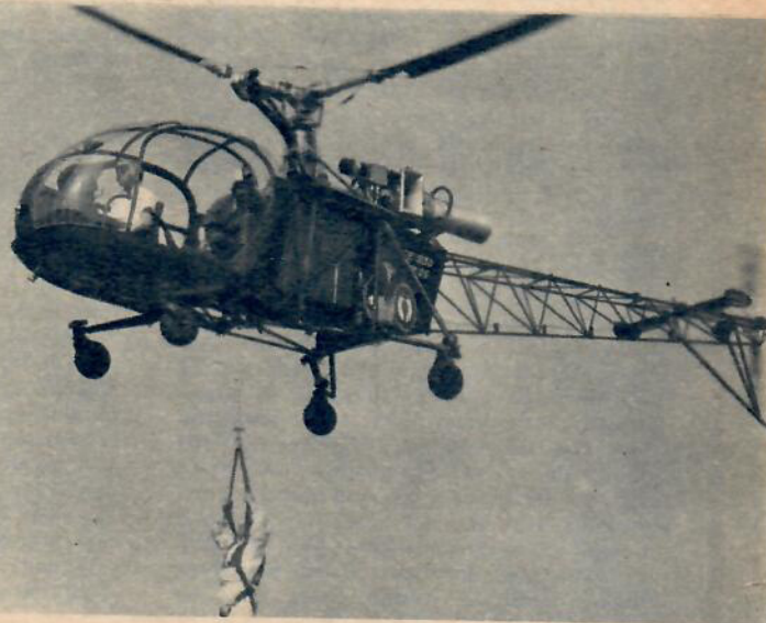
Alouette II med en Artouste II gasturbin var den första seriebyggda turbinhelikoptern. Den lyfter nästan lika mycket last som den själv väger.
