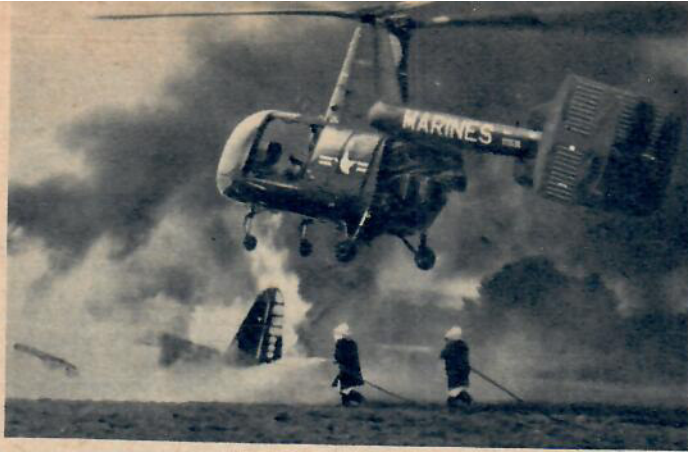
Kaman HOK som brand- och räddningsfordon. Helikoptern får fram eld-släckare och räddningsmanskop till ett havererat flygplan, blåser undan rök och flammor över brandplatsen och får skadade snabbt till sjukhus.
