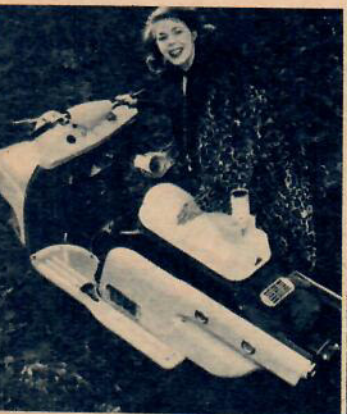
Bond-skotern är en mycket läcker skapelse med karossen helt i plast. Den väger inte mer än 130 kilo.
