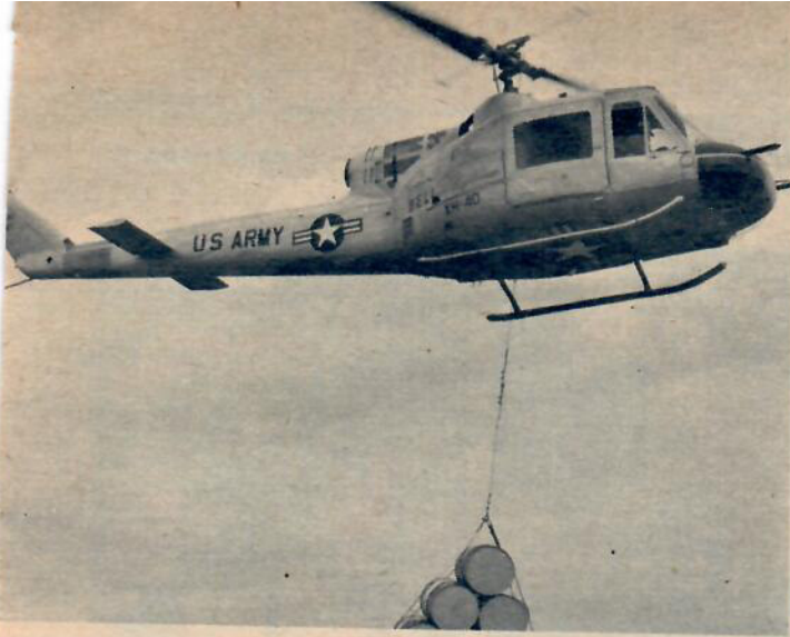
Bel H-40 med en Lycoming T-53 gasturbinmotor på 825 hk. Helikoptern kan ta sex man och har utrustning för fullständig instrumentflygning.
