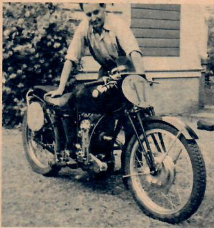
Benelli 175 cm 3 modell 1935 har i många avseenden stått modell för MV-Agustas moderna Monoalbero. Maskinen har kanske ett något risigt utseende. (Bilden t. v.) Motorn på denna cykel hade enkel överliggande kuggdriven kam. Magneten var kuggdriven.
