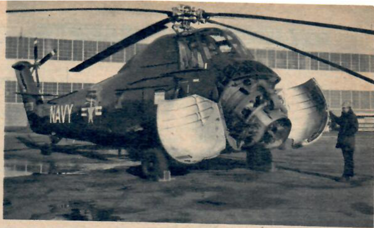
Motorinstallation med gasturbinmotorer i en Sikorsky S-58 med två General Electric T 58 turbiner. Dessa utvecklar tillsammans 2.050 hk. Samma helikopter kan också utrustas med en kolvmotor som ger 1.525 hk.
