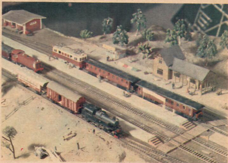
Huvesta Central är en kopia av Huvudsta Central. På bangården står, från stationen räknat, ett persontåg med GDG:s lok, vars hjulställning BOBO (B-noll-B-noll) gav det smeknamnet »Bobo». På nästa spår står ett diesellok och närmast på bilden SJ:s S-lok, en godsvagn och personvagn m/Å.
