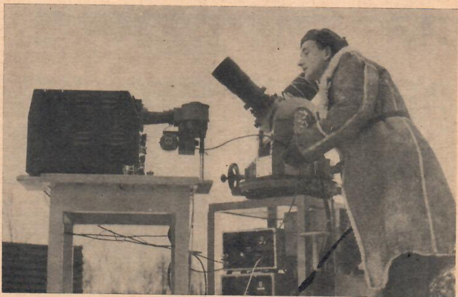
Med den här apparaturen gör Anders Omholt mätningar på de våldsamma variationerna i norrskenflammornas spektrum. Instrumentet t. h. är spektrometern och t. v. står en registrerande filmkamera.
