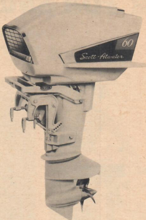
Flying Scott heter Scott Atwaters nya trecylindriga snurra på 60 hk. Den är kapabel för farter på upp till 44 knop. Motorn tippas utan besvär med en elektrisk-hydraulisk mekanism.
