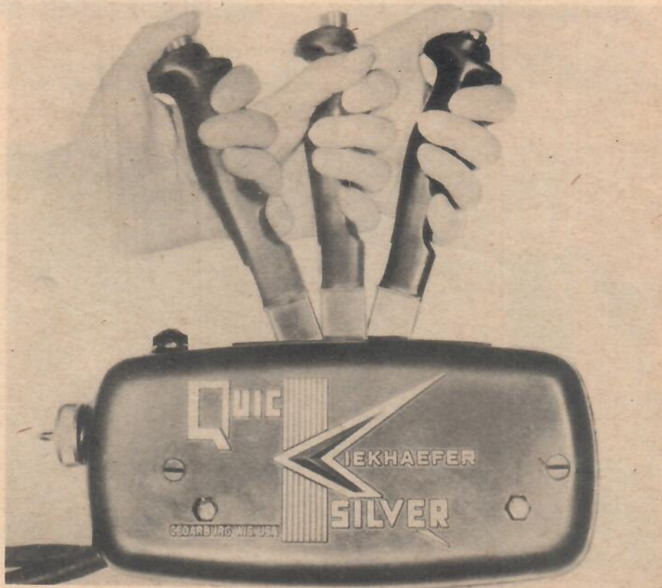
Start, gas, tomgång och back manövreras med detta enda reglage på Mercury Mark 78. Startknappen sitter överst på gasreglaget. Endast då den trycks ned helt i botten blir motorn chokad vid start.
