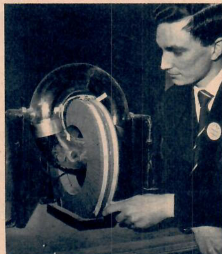
En enkel modell av ZETA. I glasröret sker urladdningarna. Den andra ringen är transformatorn som ger den inducerade strömmen i gasen.
