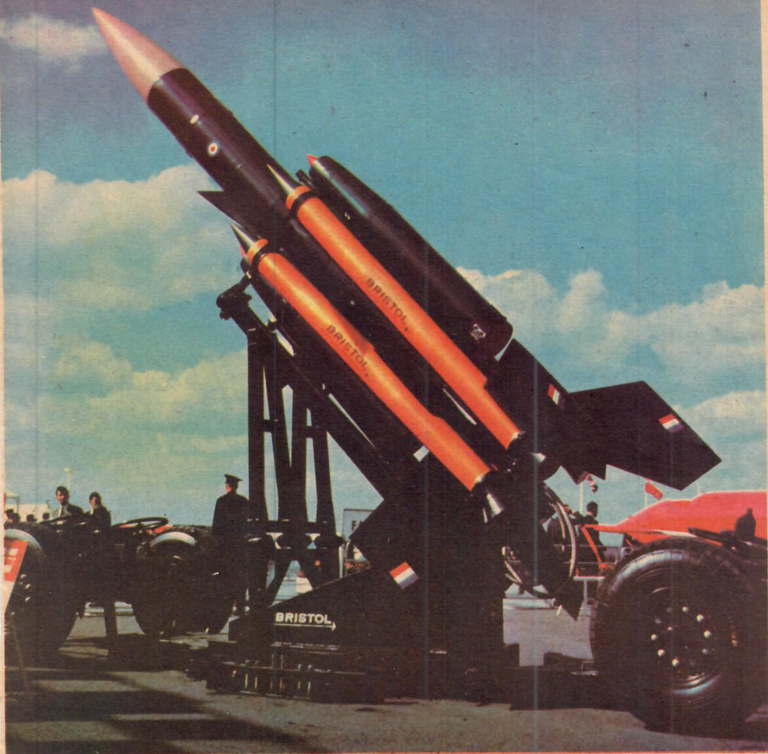
Bristol/Ferranti Bloodhound pekar hotfullt mot skyn. Roboten, som är försedd med s. k. halvaktiv radarmålsökare, är ungefär 7,5 m lång, har en spännvidd av 1,5 m och väger ca 1600 kg.
