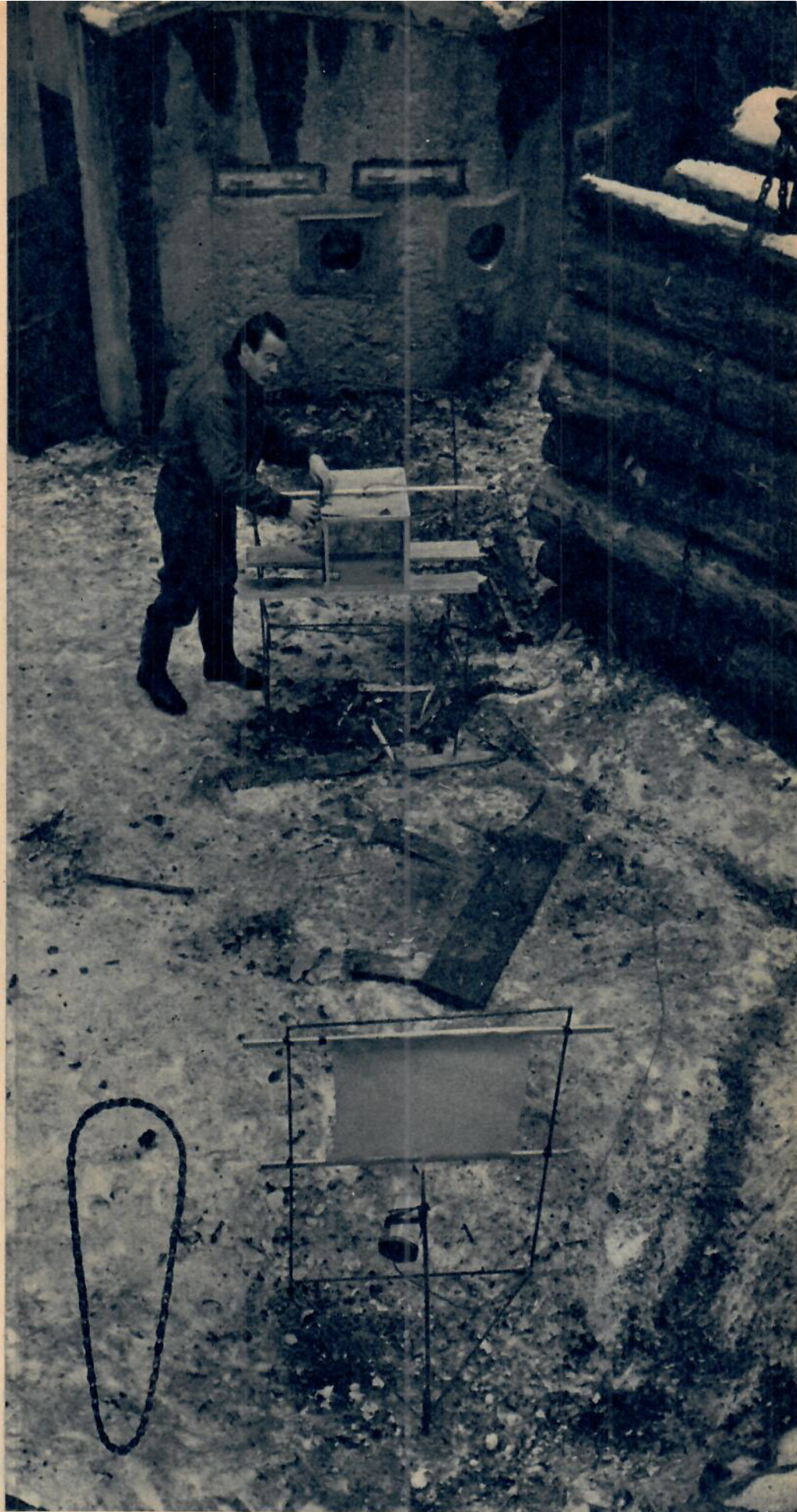
Arrangemanget vid tagningen av föregående bild. »Ateljén» är en bergsklyfta innanför höga jordvallar. I förgrunden argonblixten bakom ett papper som skall göra ljuset diffust. I mitten laborerar ing. Sternhoff med motivet nedsänkt i ett akvarium. Längst bort betongbunkern för kameran.
