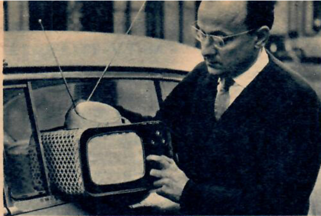
André Tannino, ägare av en stor parisisk radio- och TV-tidning har konstruerat en portabel televisionsmottagare som kan användas i bilar. Bildytan är liten — 9 tum — och apparaten väger bara 7,5 kg.
