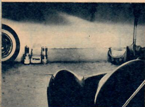
Har ni asymmetriskt ljus skall halvljusbilden se ut så här. Man ser ljustrianglarna som ger det längre halvljuset på vägens vänstra sida.
