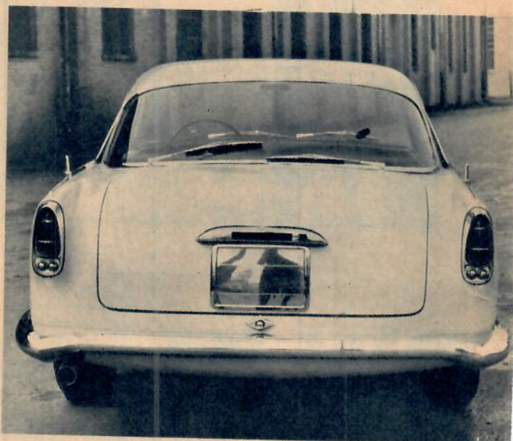
Det är de små små detaljerna som gör det. Tre och en halv liters GT har dubbla vindrutetorkare på den stora bakrutan. Perfekt sikt runt om.
