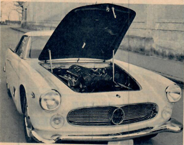
En titt i motorrummet visar kanske inte den allra bästa åtkomlighet i servicehänseende men de vanligaste detaljerna ligger hyfsat till.
