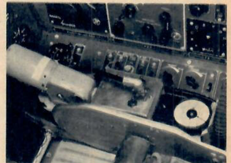
På varvräknaren t. h. på bilden avläses den växelfrekvens höger-vänster, som bilden i siktet visas med. Inställningen sker med en kontinuerligt varvtalsreglerbar strömväxlare.
