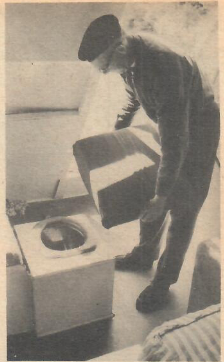
Här är maskineriet. Aktersnurran ger den behagliga farten av fyra knop. Den låga bensinförbrukningen gör att den går länge på en uppdragning.
