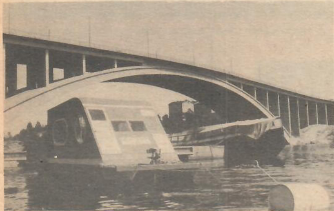
Serieversionen kommer att få dörren mitt på framväggen så att innerutrymmet blir större. Av samma anledning blir framväggens lutning brantare.
