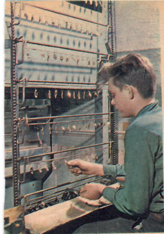
◀ Automat för lackering av beten. Här är det Torsjö-draget som skall få sina röda fenor.
