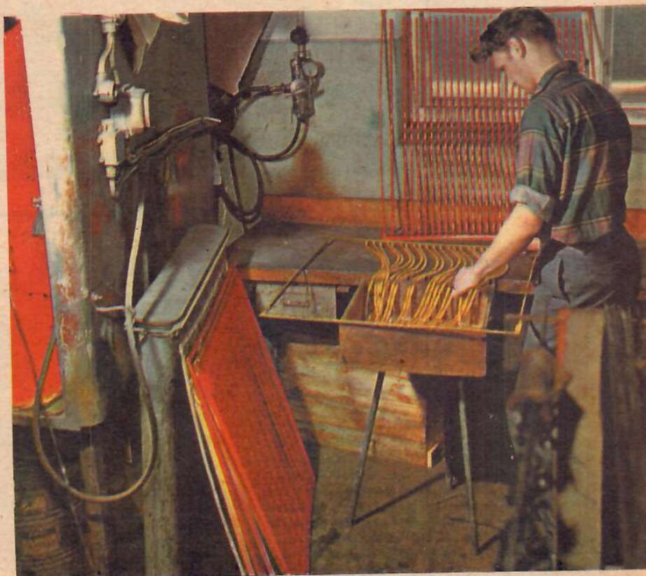
ABU-spinnaren innehar världsrekordet när det gäller produktionssiffror. Inte mindre än 8 miljoner exemplar har hittills tillverkats. Spinnaren används med framgång som bete för olika slags fisk i alla delar av världen. Här en bild från lackeringen av kropparna.
