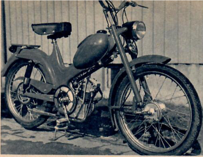
Marknadens enda moped med fyrtaktsmotor är den italienska Ducati. Fyrtaktsmotorn är i många avseenden överlägsen tvåtakternas konstruktionen blir mer komplicerad. Mopeden verkar mycket gedigen.
