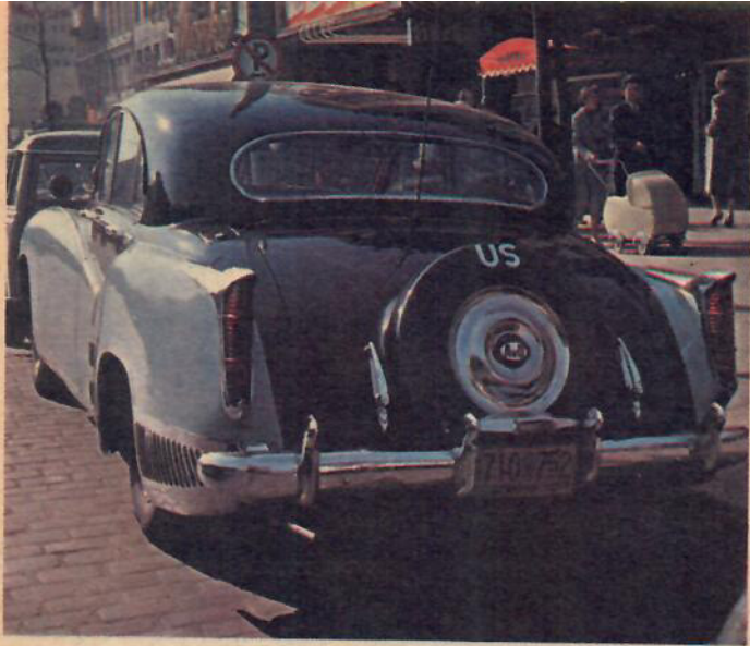
Sedd bakifrån visar Jaguaren upp de flesta personliga detaljerna. Reservhjulet har lagts utpå karossen och kapslats. S. k. Continental-kit. Bakflyglarna har uppbyggts och förlängts med extra fenor à la Cadillac.
