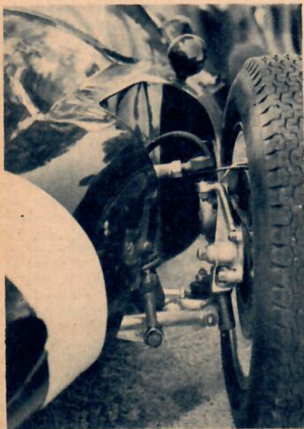
En närbild på Coopers framvagn visar skivbromsar, trapetslänk och hydraulisk stötdämpare.
