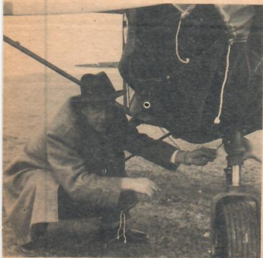
Med ett enkelt kapell över nospartiet med motorn skyddar Drott Gyllenberg sitt plan perfekt.
