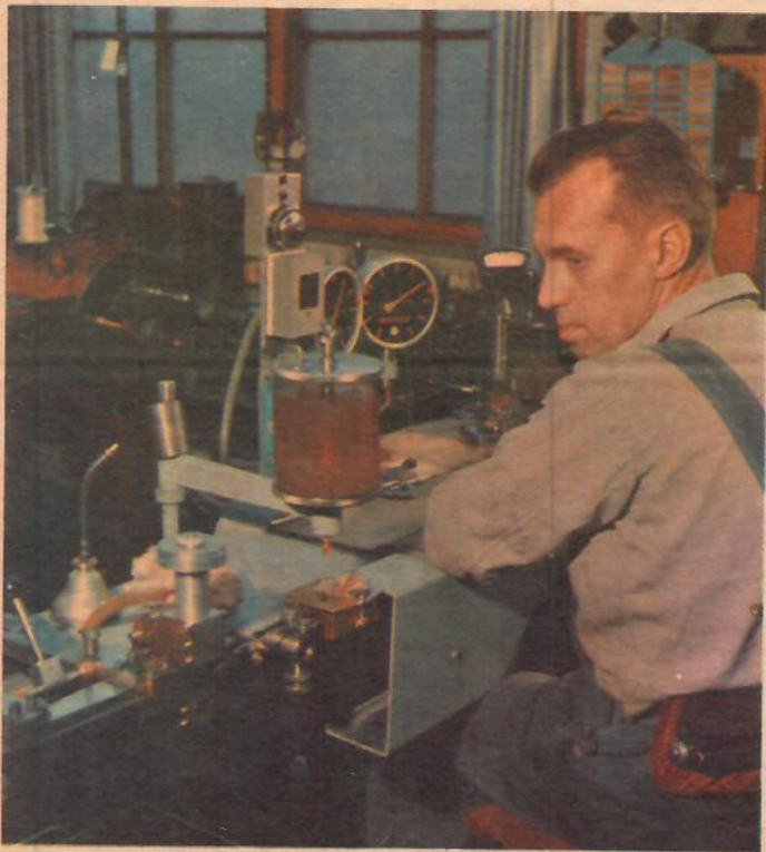
Mycket av sandviksstålets värde ligger i precisionen. Med detlameterns hjälp kollar synare Arne Åsberg tusendels millimetrar på urfjäderstål.
