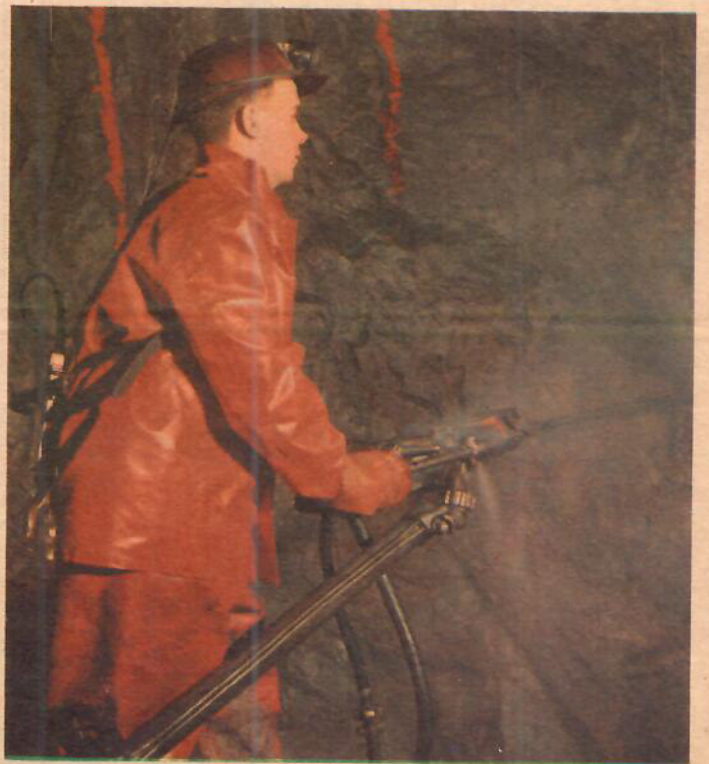
I Bodås-gruvan fyra mil från verket sluts sandviksstålets cirkel. Bergborrar av sandviksstål testas mot det berg ur vars malm de framställts.
