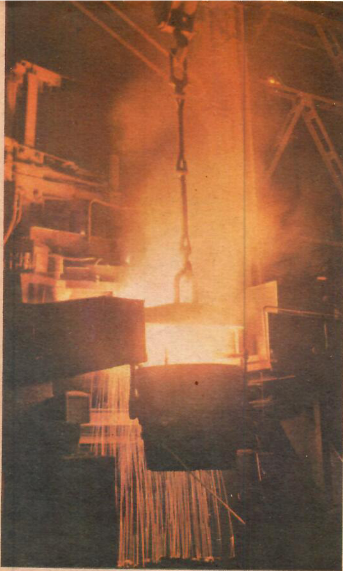
Järnvamp, tackjärn och skrot matas in under elektrostålugnens ljusbågar och när ugnen tappas har sandviksstålets långa förädlingsprocess börjat.
