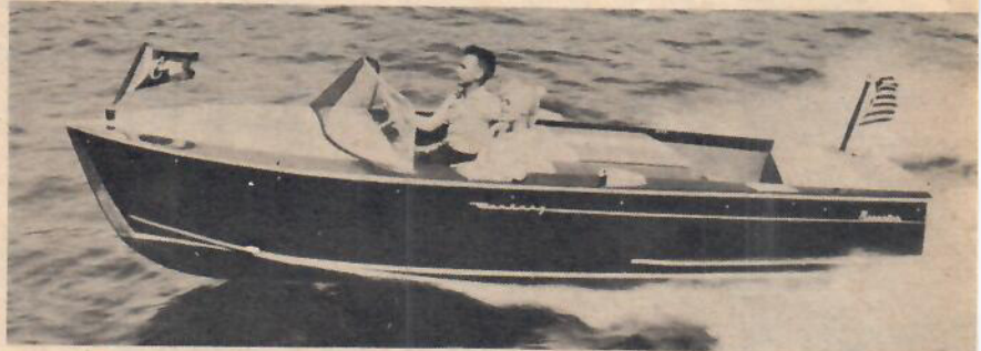
Century Resorter 16 är officiellt klassad för de amerikanska vattenskidtävlingarna. Med en Dearborn Interceptor V-8:a på 185 hk ligger toppfarten nära 40 knop.
