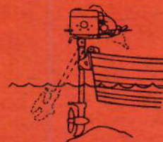
Grundstötsäker — räddar propellern vid grundstötning
