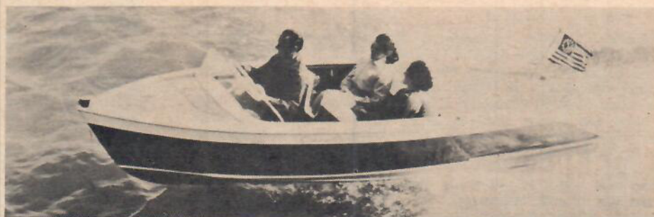
Här är en annan smacker passbåt från Cavalier. Den är 4,5 m lång och har en 60 hk motor, som ger båten en fart av 26 knop. Båten kostar i USA komplett med vindskydd etc. omkring 9.700 kr.
