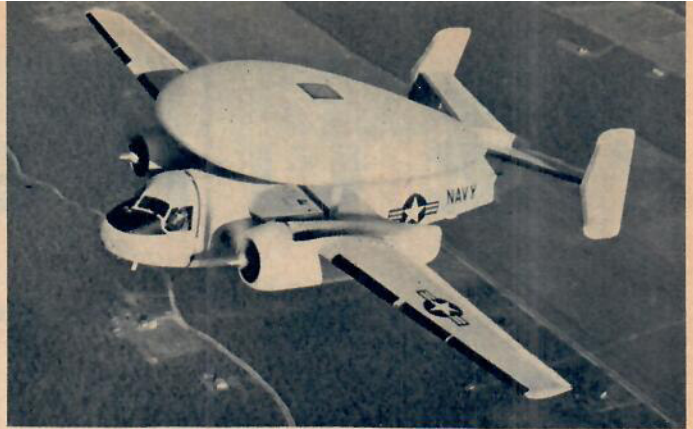
Bilden ovan visar den amerikanska flottans nya varningsflygplan Grumman WF-2 med den väldiga, strömlinjeformade radomen. Bilden nedan visar två TF-1 Trader. WF-2 kan sägas vara en utveckling av TF-1 Trader.
