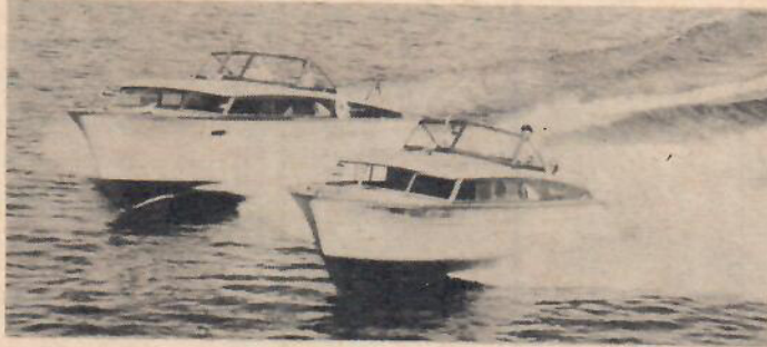
Roamer Steel Boats tillverkar motorbåtar med stålskrov. Här är firmans två typer, en 10,5 m motorkryssare (t. v.) och en mindre typ på 8,5 m.
