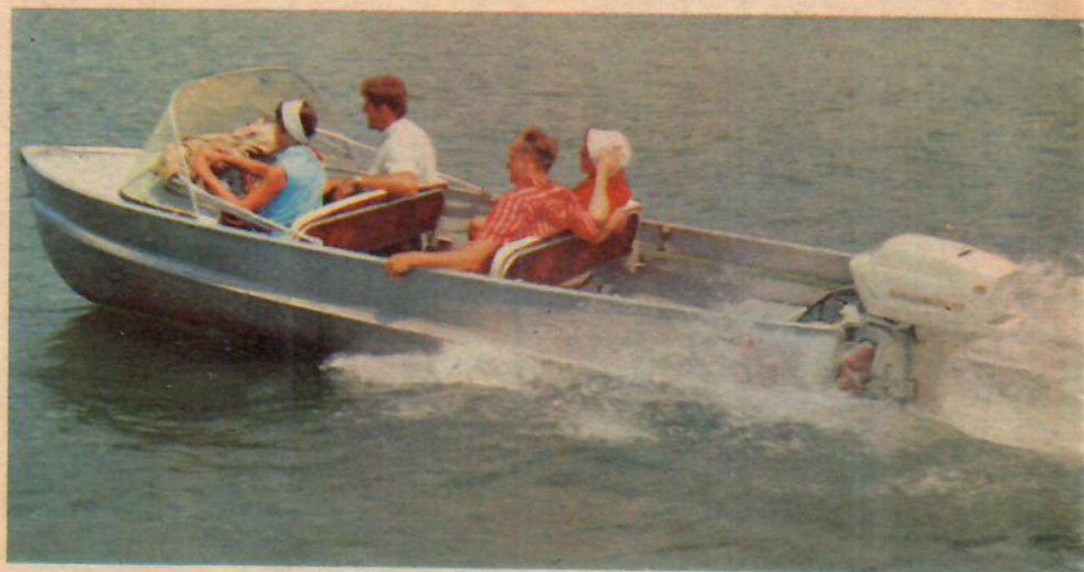
Här är en snabb passbåt av en i Amerika vanlig typ. Lägg märke till däckbryggan mellan de båda sittrummen. Det eleganta skrovet är av mahogny. Båten har prydligt — och underhålls-krävande — ribbdäck. Snurran är en Evinrude.
