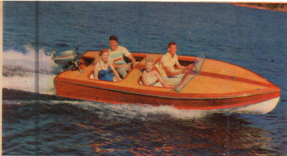
Här är en snabb passbåt av en i Amerika vanlig typ. Lägg märke till däckbryggan mellan de båda sittrummen. Det eleganta skrovet är av mahogny. Båten har prydligt — och underhålls-krävande — ribbdäck. Snurran är en Evinrude.
