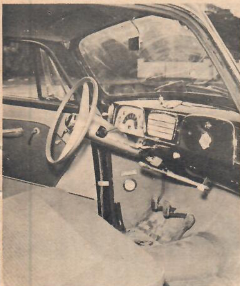
Bilens inredning och finish lämnar inget övrigt att önska. Instrumenten ligger väl samlade framför föraren och är lätta att avläsa. 56:ans hårda fjädring i kopplingspedalen har försvunnit och pedalen arbetar nu mycket smidigt.
