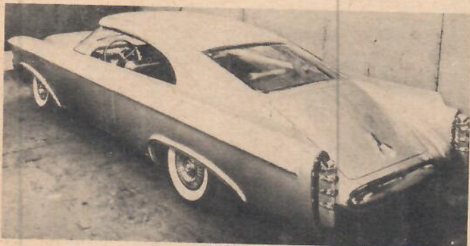
En bil som väl troligen aldrig kommer att kunna visas för publik är Chryslers Ghia-Norseman. Ett år tog det att få fram bilen som visar sådana originella detaljer som tak i »brokonstruktion». Hela taket bärs upp bak till. Inredningen svämmade över av diverse strömbrytare för fönsterhissar, sätesinställning osv. Ryggstöden i framsätet kunde svängas för passage till baksätet. Hela härligheten gick till botten med Andrea Doria.
