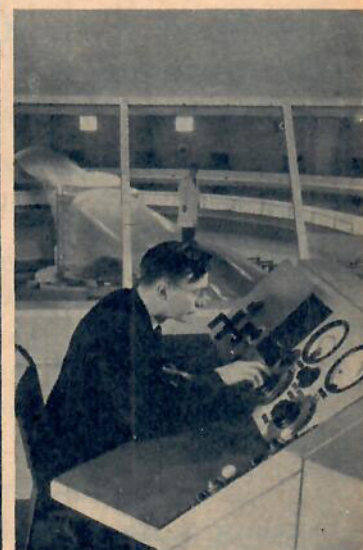
Bakom instrumenttavlan skymtar den ringformade bassängen med den 36 m långa, roterande testbalken. Bassängen rymmer 250.000 l finfiltrerat, mycket klart vatten
