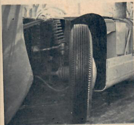
Här en bild av framhjulsfjädringen. Spiralfjädrarna, styrstag och stötdämpare syns tydligt.
