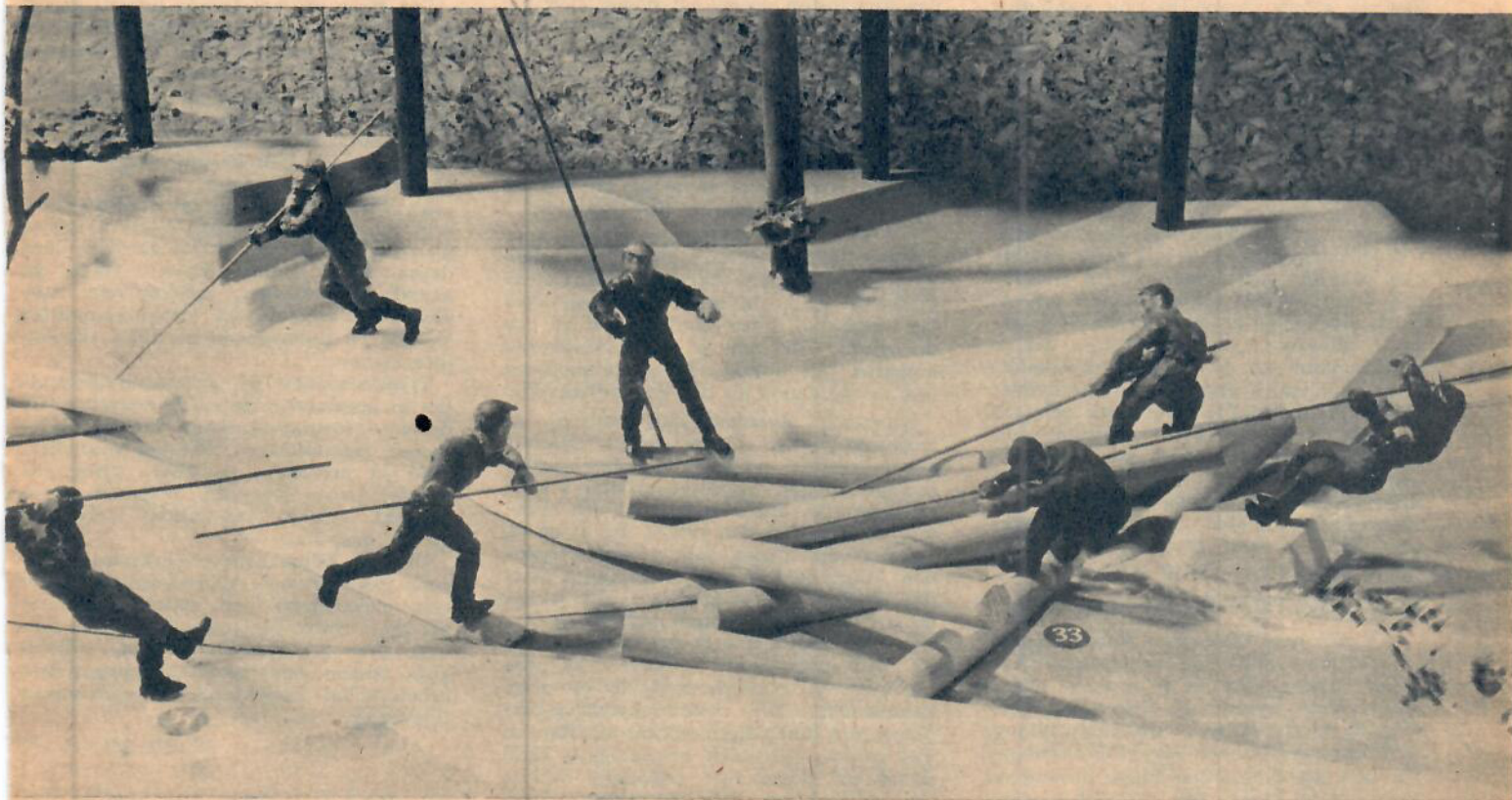
En dramatisk scen i Föreningen för arbetarskydds utställning. Med skärpa framhävs hur de båda flottarna längst t. v. och flottaren t. h. utsätter sig för livsfara genom att använda båtshaken fel.
