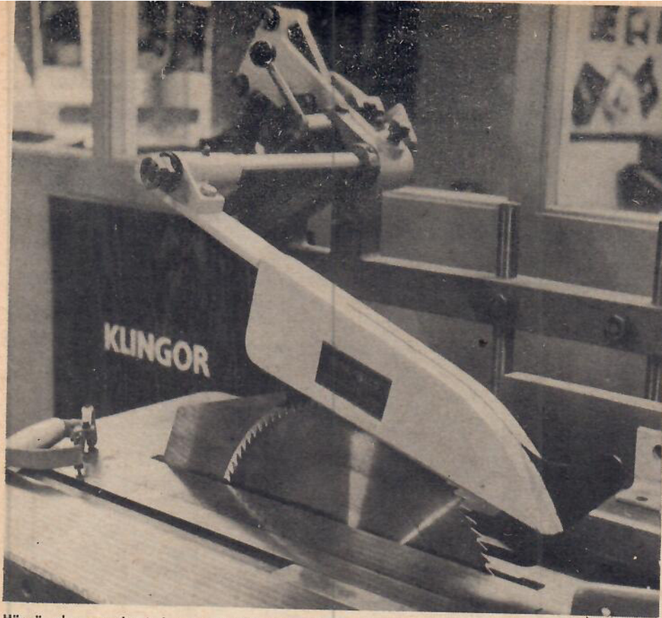
Här är den svenska industrins kanske farligaste maskin, den vasstandade, racerbilssnabba cirkelsågen. Rörligt Suva-skydd över klingan och en lämplig kniv, som skyddar mot bakåtkast, ger säkerhet.
