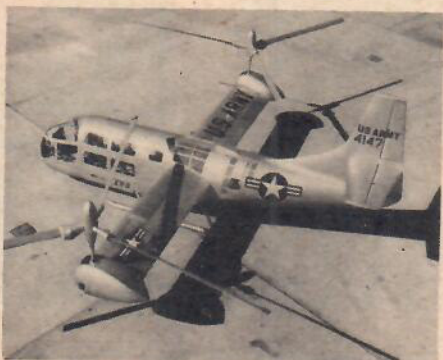
Konvertiplan Bell XV-3 är en korsning mellan helikopter och vanligt flygplan. Rotorerna svänger över till lodrätt läge vid planflykt. Planet tar fyra passagerare och gör 280 km/t.
