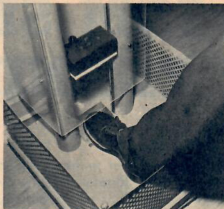
Täskador är vanliga i vissa industrier, jobbarna tappar tunga saker på fötterna. Här dimper en 7-kilosvikt från två meter ned på foten!
