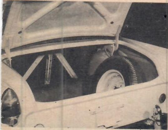
Bagageutrymmet är stort och praktiskt utformat även om den höga bakre plåten gör att bagaget måste lyftas ganska högt när det skall lastas in i bilen.
