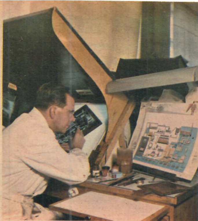
Retuschen är ett led i framställningen vid offset. Här är det Georg Stylander, som finputsar ett av negativerna från färgseparationstagningen.
