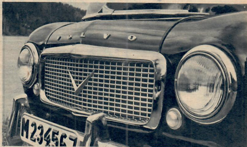
Fronten på Pv 444 L visar upp en del smärre förändringar i jämförelse med den gamla modellen. Kylarmaskeringen har begåvats med ett V-tecken och blinkers har placerats under huvudstrålkastarna.
