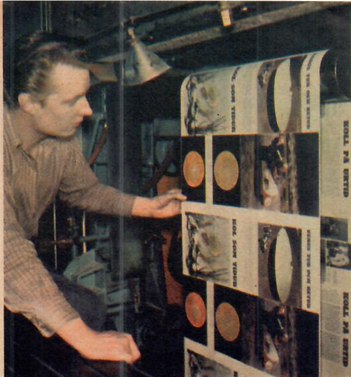
Harry Knutsson tar sig en titt på färghållningen. Han kontrollerar att färgerna är jämna och att varje färgverk ger tillräcklig mängd färg.
