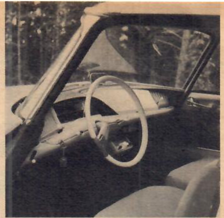
Instrumentpanelen är toppmodern. »Dragspelen» på båda sidorna är reglerbara friskluftintag.
