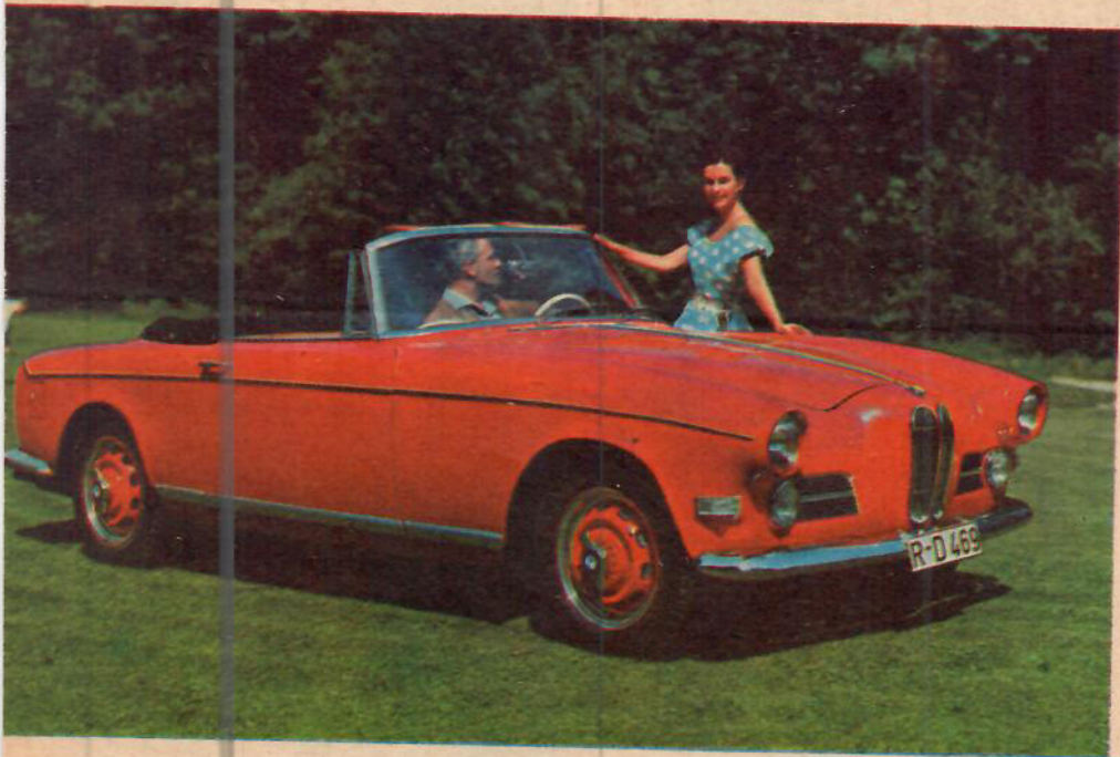
BMW 503 är en sportig upplaga av den mera standardbetonade 502:an. Motorn är en 3,2 liter på 140 DIN-hästar som ger en toppfart på cirka 190 km/t. En verkligt rasren och vacker sportvagn.
