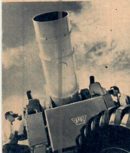
Teleskopet på bilden är det första rörliga i sin storleksklass som tillverkats i USA. Det används vid fotografiering av robotar och flygplan i luften. Max. brännvidd 8 m.
