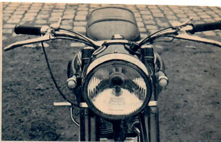
På styret sitter tändnings- och chokereglagen. En intressant detalj är de dubbla parkeringsljusen på sidan om strålkastaren som är standard.
