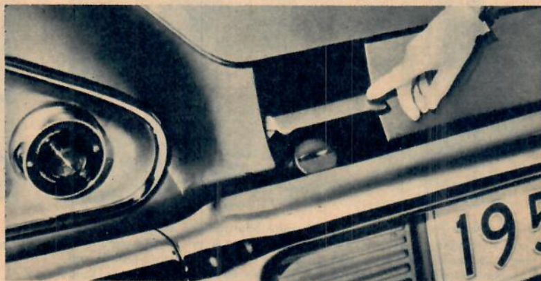
I år har Chevrolet gömt bensinpåfyllningen bakom en lucka vid kofångaren i stället för vid bromsljuset som förra året (bilden överst). En praktiskt detalj på sportmodellen Impala syns nedan. På insidan av dörren sitter en lampa som dels tjänar som belysning vid instigning, dels är en varningsreflex för bakifrån kommande bilar.
