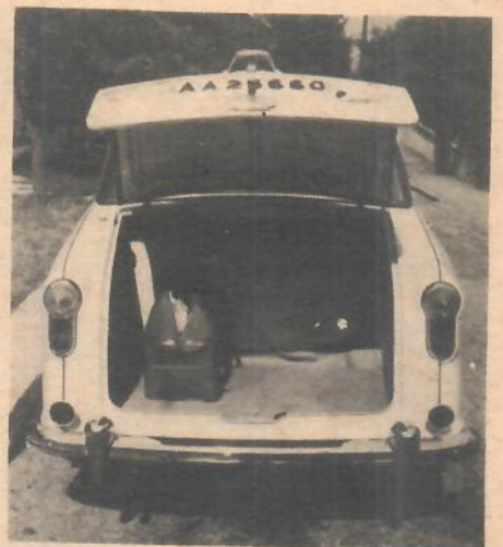
Vi lyfter på bagageluckan och tar en titt innanför. Reserven finns i särskilt fack under golvet.
