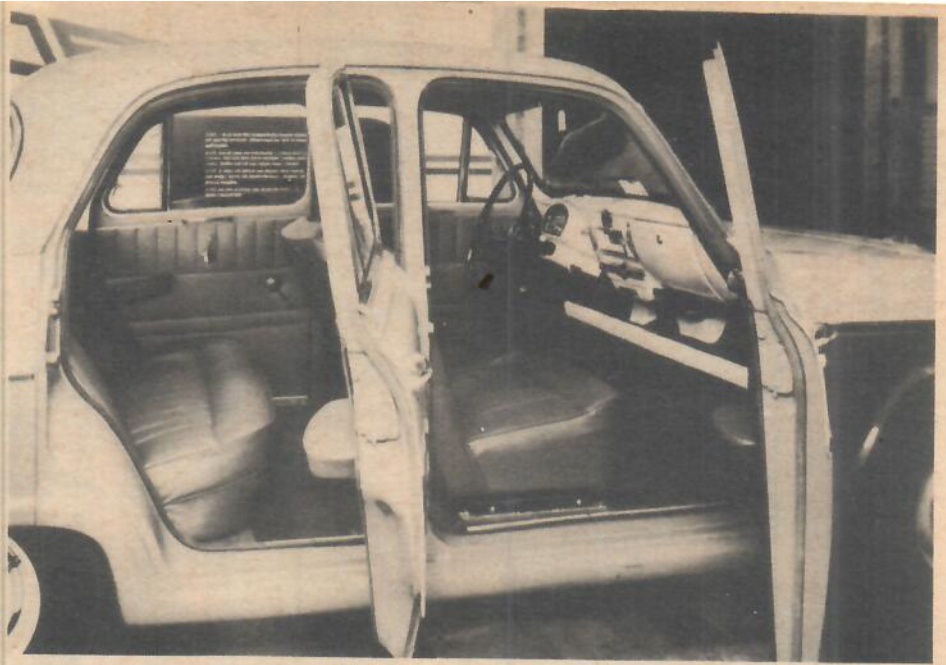
Dörrarna är upphängda på riktigt sätt, dvs. i framkanten. De är stora och möjliggör bekväm in- och urstigning. Pakethyllan i framsätet är ändamålsenlig men kan vid en krock vara farlig »benkrossare».
