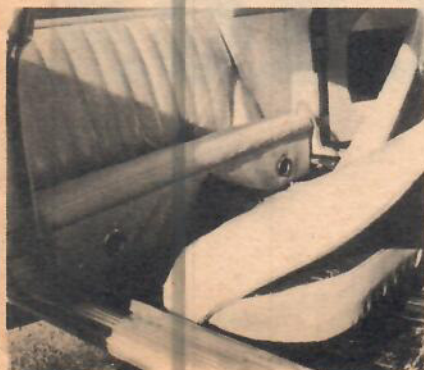
Baksätet kan tas loss och lämnar då en del plats för bagage under långfärder. (Ovan.) Med sätet på plats kan ett par barn, modell mindre få plats. Hålen på framkant är för värmen. Bilden nedan.
