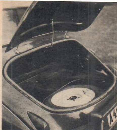
Bagageutrymmet i höjdlid är inte mycket att skryta med. På bredden rymmer det dock en hel del. Reservhjulets placering tillhör dock det mindre lyckade på Dekan.
