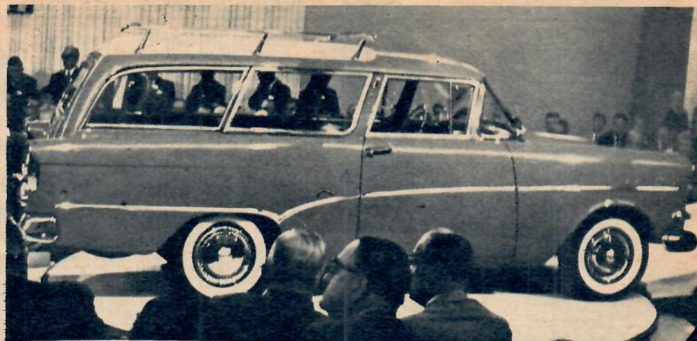
En snygg exponent för stationsvagnarna var den nya Opel Caravan. Motor och växellåda desamma som på Rekorderna. Utförandet på bilden är inte standard men Caravan ser faktiskt snyggast ut med takracket än utan. Grann sak. Stolarna i karran är fällbara och ger ett plant lastutrymme baktill.
