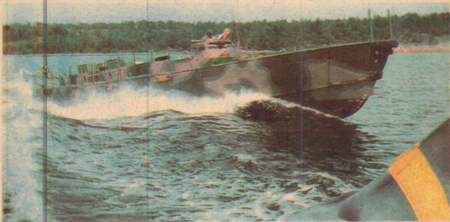
200-båtarna är något för Sveriges del alldeles nytt i fråga om landstigningsbåtar. Ljudlöst, i jämförelse med tidigare modeller, och med 20 knops fart för de heltäckta båtarna fram 60 man som släpps iland genom två luckor i fören. Motorutrustningen är tre Scaniadieslar på sammanlagt 600 hk.
