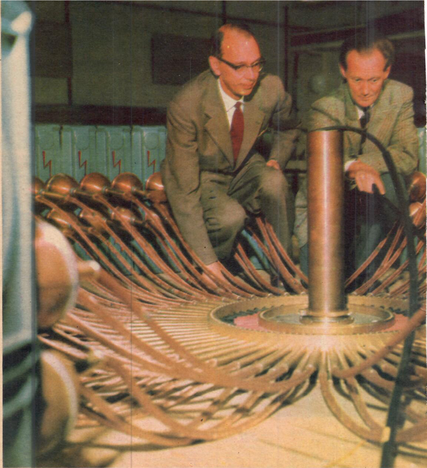
Professorerna Per Ohlin t. v. och Kai Siegbahn vid apparaturen för s. k. fusionsexperiment. Genom kopparmantlade kablar förs den energi som samlats i ringen av kondensatorer ned i urladdningsröret där effekten under några miljondels sekunder är ca 100 gånger den i Harsprånget.
