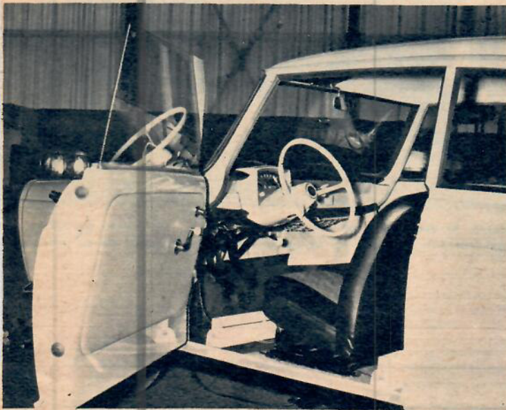
Inredningen på »Lilldekan» är gedigen. Hängande pedaler, rattväxel och instrumenttavla à la TV-apparat. Priset i Tyskland omkring 6.000 kronor.
