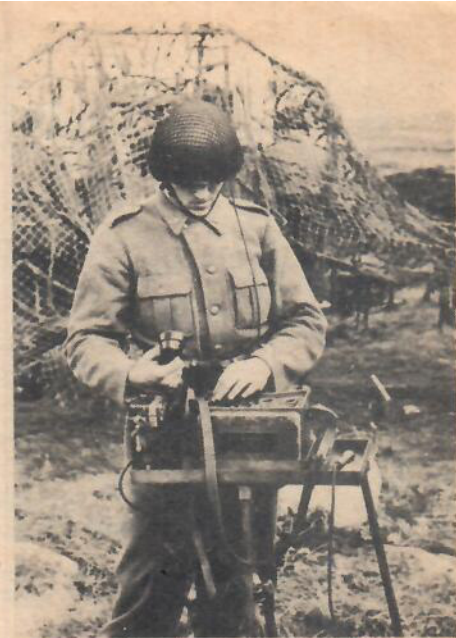
När allt är klart för eldgivning tänder centralinstrumentet en grön lampa framför eldledaren som trycker på en knapp och kanonerna skjuter.
