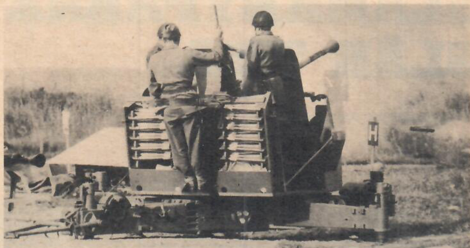
I sekundjakten ingår att öka eldhastigheten. Den moderna 40 mm luftvärnskanonen, ovan, skjuter fyra skott per sek. medan 57 mm skjuter två.
