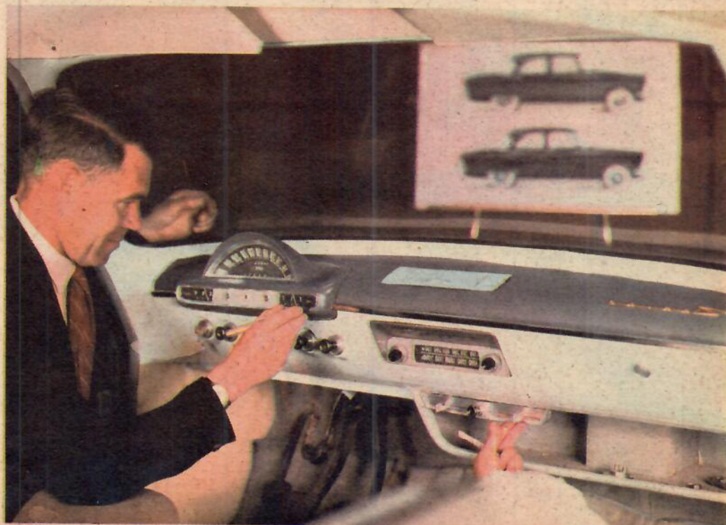
Ett förslag till en instrumentbräda kan se fint ut på en teckning men inte förrän man gjort en modell kan man säga om den blir riktigt praktisk och lätthanterlig för föraren.
