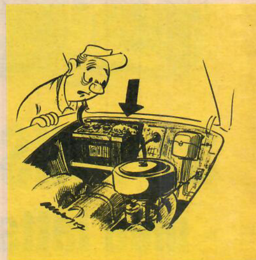
Kabelskorna på batteriet får inte se ut som en möjlig limpa. Gör rent ordentligt från oxiden.
