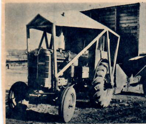
Två exempel på goda skydd över förarplatsen. Trots olyckorna hör de till sällsyntheterna.
