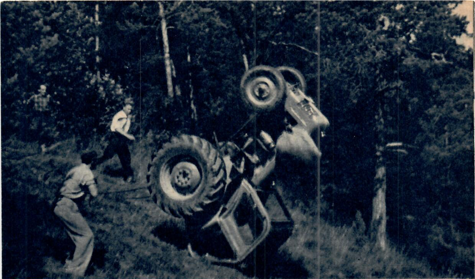
Trots extrabelastning framme på motorhuvud stegrar sig en traktor lätt i ett motlut om lasten är stor. Endast en kraftig hytt eller bastanta skyddsbyglar kan rädda föraren från att bli krossad.
