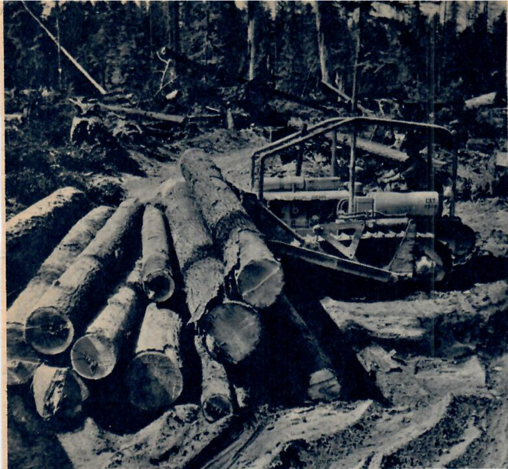
Skyddsbyglar av den här typen kostar inte mycket att montera på traktorn men ger ett effektivt skydd om traktorn stjälpes eller stegrar sig. Föraren är dessutom skyddad mot nedfallande gods.
